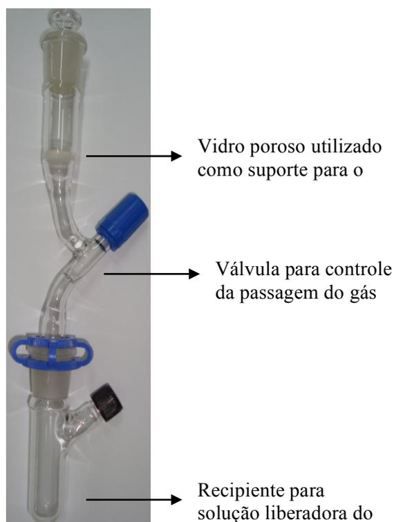
**Figura 4.1:** Vidraria desenvolvida para a coleta do tempo de resposta ao gás amônia dos sensores.
