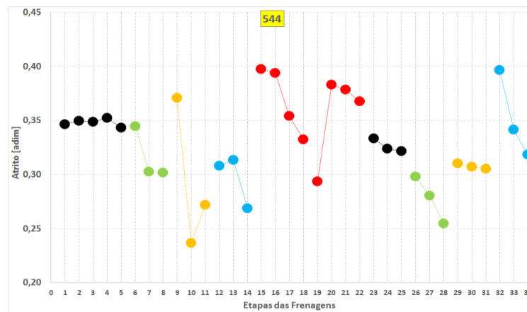
Figura 6.3 – Coeficiente de atrito x etapas de frenagens do material NAO (Fonte: LATRIB-UFRGS)
