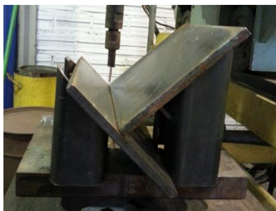
Figura 4.1: imagem das chapas sobre o gabarito para a produção dos corpos de prova
