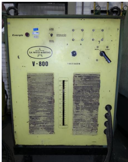
Figura 4.2: Fonte de soldagem White Martins Unionmelt AS 800
