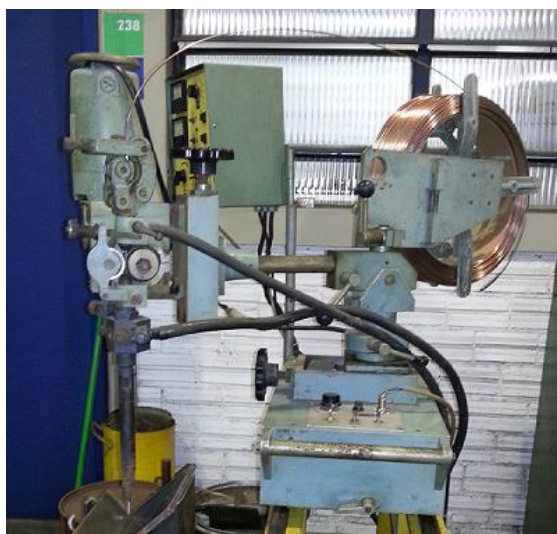
Figura 4.3: carro propulsor e sistema de alimentação do arame
