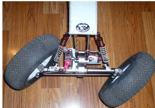
Figura 9: Sistema de direção tipo Ackerman, adaptado de: (RCCRAWLER, 2013).
