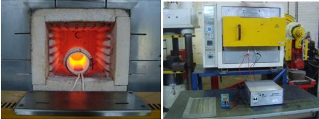
Figura 61 – Forno de recozimento com indução magnética (Forno 4,5 kW/1250°C)
