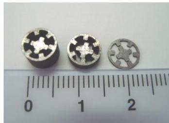
Figura 49 – Detalhe do conjunto rotor/estator, após o “corte a fio” da “Chapa Elétrica”, ABNT 35F 420M
