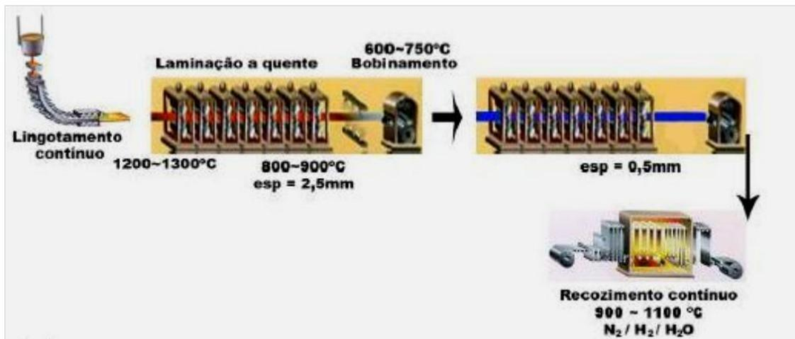
Figura 29 – Processo de fabricação dos aços elétricos GNO
