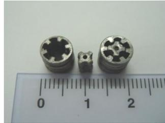
Figura 47 – Detalhe do rotor/estator após o “corte convencional” da “Chapa Elétrica”, Aço ABNT 35F 420M
