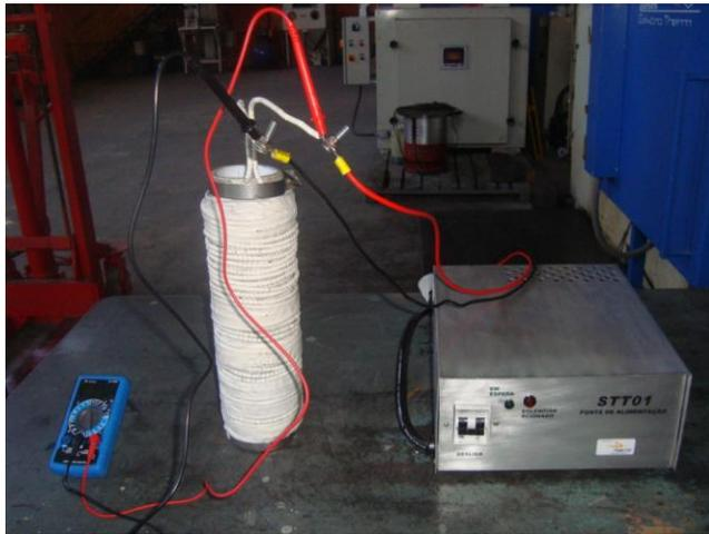
Figura 60 – Bobina de indução magnética e fonte de alimentação
