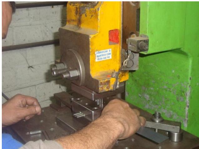
Figura 45 – Operação de corte da “Chapa Elétrica”, ABNT 35F 420M
