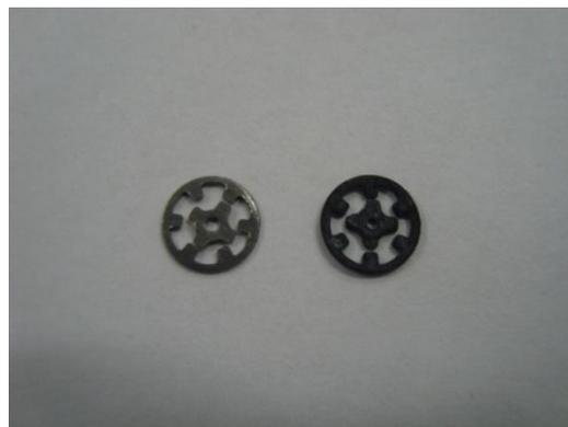
Figura 57 – Conjunto rotor/estator MEV, “processo de corte convencional com tratamento térmico e indução magnética”, Chapa Elétrica, ABNT 35F 420M
