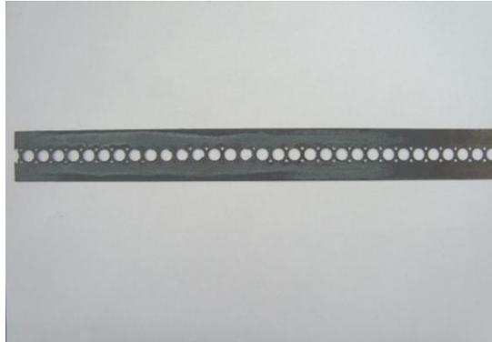
Figura 42 – “Chapa elétrica com corte convencional e RCIM”, Aço ABNT 35F 420M.
