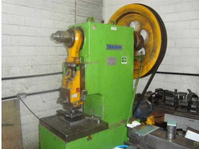
Figura 44 – Prensa Frasson 45 toneladas para corte da “Chapa Elétrica”, ABNT 35F 420M
