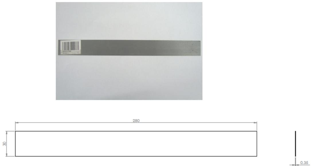
Figura 40 – “Chapa Elétrica sem corte” Aço ABNT 35F 420M
