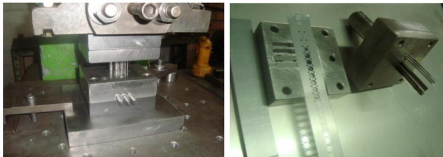
Figura 46 – Ferramenta de corte da “Chapa Elétrica”, ABNT 35F 420M
