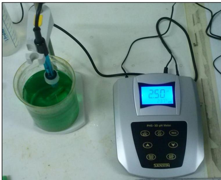
Figura 4.4 Imagem do pH-metro utilizado da marca Sanxin, modelo PHS-3D
