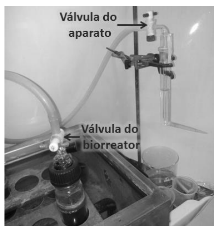
Figura 1 – Disposição dos instrumentos para realização da medida de volume total de gás gerado.
