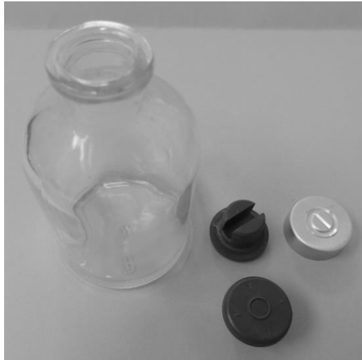
Figura 12. Frascos tipo penicilina de 50 mL, com tampa de borracha e lacre de alumínio, utilizados para o isolamento de microrganismos coletados dos biorreatores.
