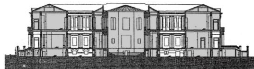
Figura 15- corte longitudinal da Pinacoteca antes da reforma, mostrando os pátios descobertos e o vazio no octógono central
