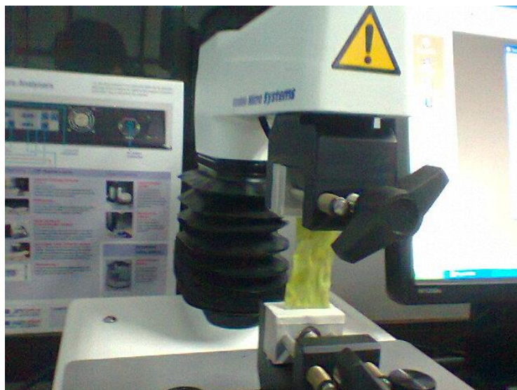
FIGURA 11. Texturômetro modelo TA – XT2i apresentando fragmento de folha de alface para medição da força de cisalhamento na folha de alface. Porto Alegre – RS, 2014.
