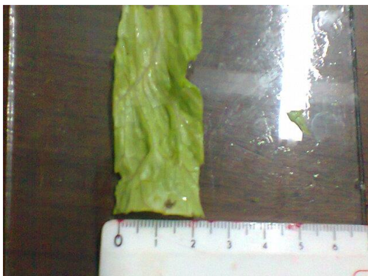
FIGURA10. Preparo de folha de alface para medição de força de cisalhamento em texturômetro modelo TA – XT2i. Porto Alegre – RS, 2014.
