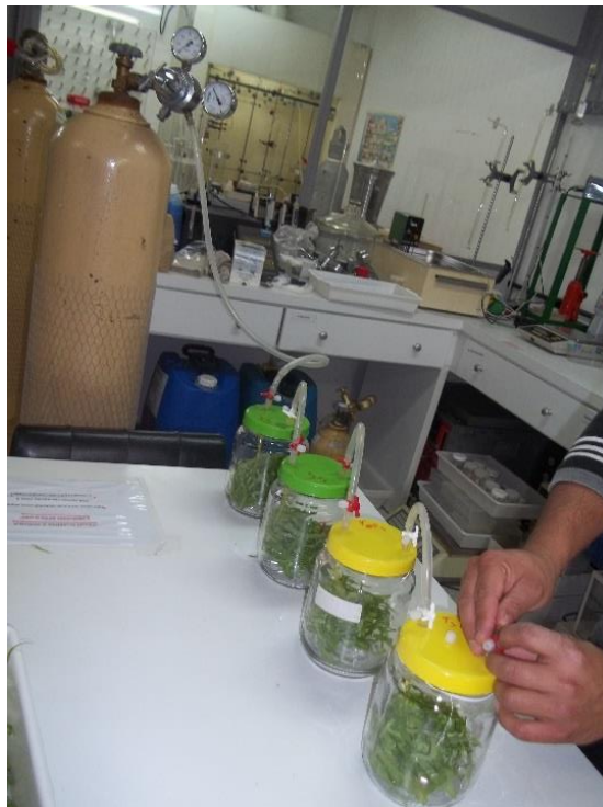
FIGURA 2 . Injeção de gas nas concentrações de 5 kPa de O_2 e 15 kPa de CO_2 em recipientes com couve. Porto Alegre – RS, 2014.
