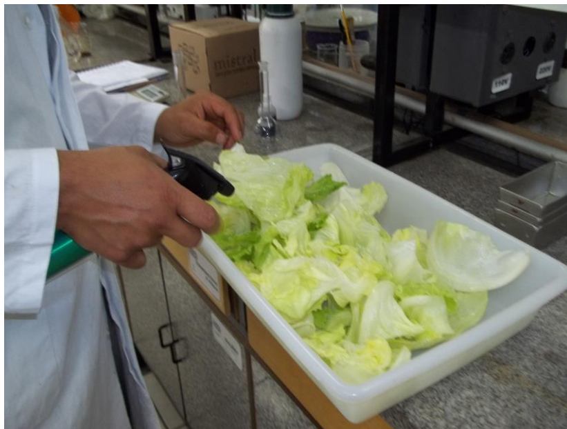
FIGURA 5. Folhas inteiras de alface sendo aspergidas com solução de quitosana por borrifador manual. Porto Alegre – RS, 2014.
