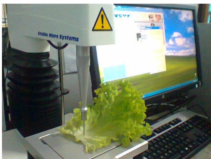
FIGURA 12. Avaliação da resistência à penetração do talo da folha inteira de alface em texturômetro modelo TA – XT2i. Porto Alegre – RS, 2014.
