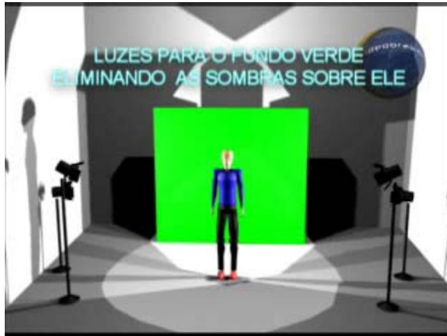
**Figura 4.30:** Ilustração mostrando um esquema de distribuição de lâmpadas para eliminar a sombra na parede verde que será usada o efeito *chroma key*. **Fonte:** <http://tutorfreebr.blogspot.com.br/2012/11/segedos-revelados-do-chroma-key.html>
