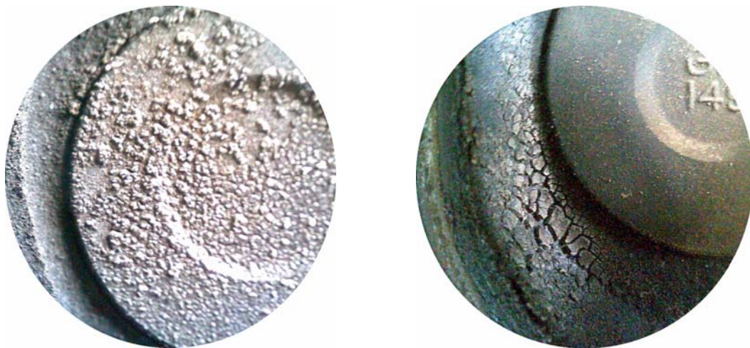
Figura 6. 20 – Detalhes da carbonização junto às válvulas na tampa superior do motor.
