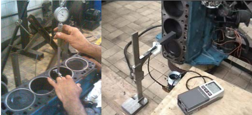
Figura 5.4 – Medição de conicidade, ovalização (à esquerda) e rugosidade (à direita) dos cilindros.
