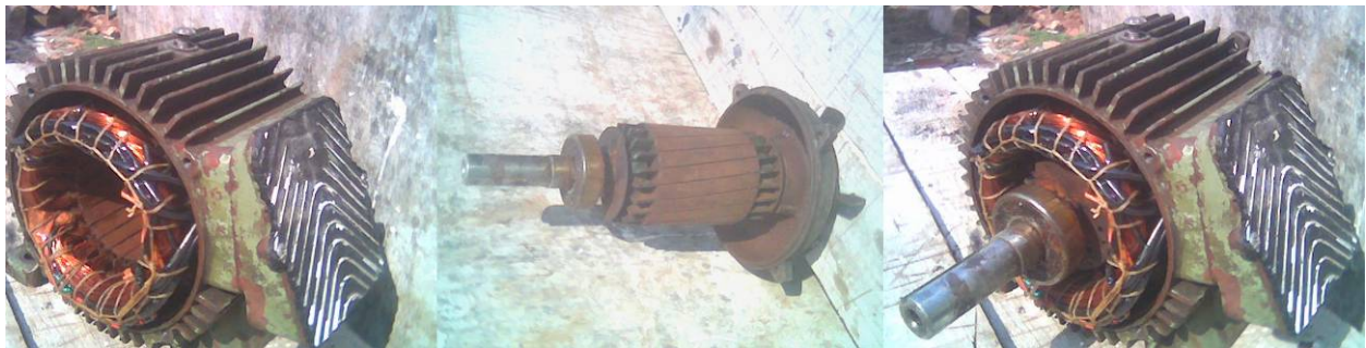
Figura 4.8 – Estator, rotor e motor assíncrono parcialmente integrado.
