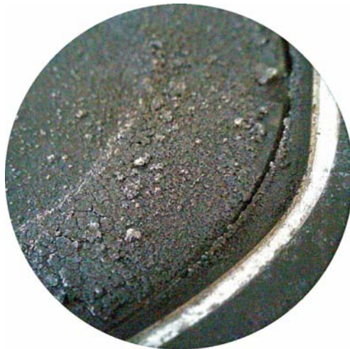
Figura 6.18 – Detalhe da carbonização da face superior do êmbolo número um.
