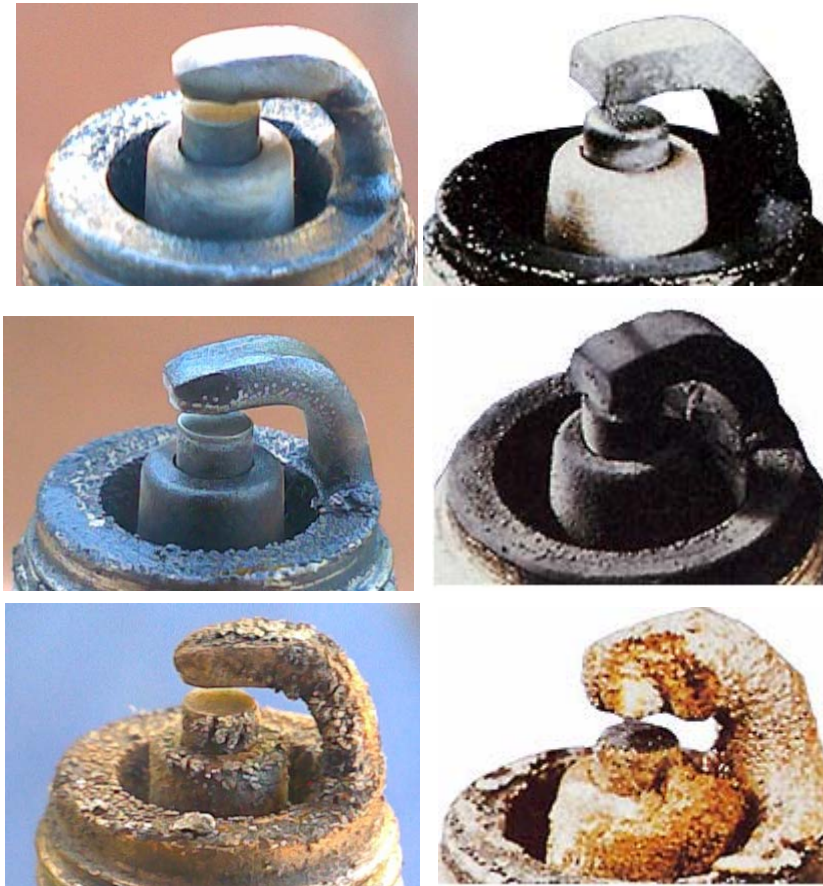
Figura 6.21 – Comparativo entre vela do protótipo (à esquerda) e o modelo do fabricante (à direita), para 25h, 165h e 295h. Fonte: Bosch (2006).
