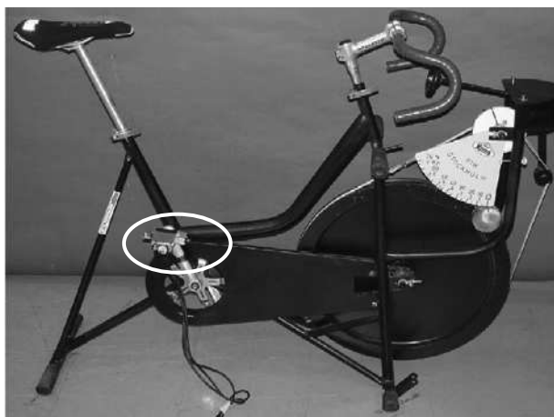
FIGURA 1 - Cicloergômetro da marca Monark (modelo GIH - Stockholm, Sweden) com ajuste manual de carga.
