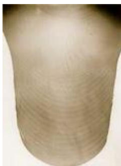
Figura 2: Seção transversal típica de uma solda por fricção com pino consumível. Liga de alumínio 6082 depositado em alumínio comercial puro, indicando séries de planos de cisalhamento.
