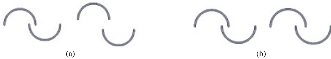
Figura 2.4 – (a) afastamento das pás, (b) sobreposição das pás [adaptado de Akwa, 2010]
