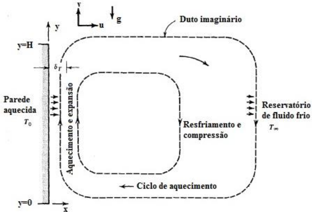
Figura 3.2 – Ciclo térmico imaginário responsável pela convecção natural (Adaptado de Bejan, 2004).
