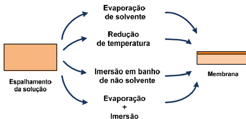
Figura 2.6: Principais técnicas de indução de separação de fases em sistemas poliméricos. Extraído de Ambrosi (2012).
