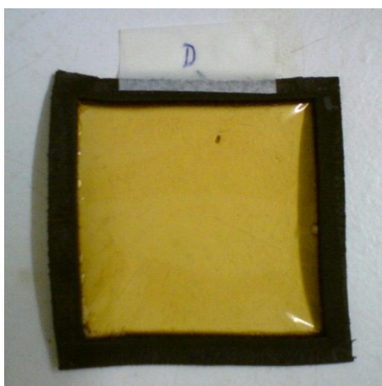
Figura 4.1: Fotografia da membrana sintetizada a partir da solução D e reticulada com Acetaldeído 1:1 QS.
