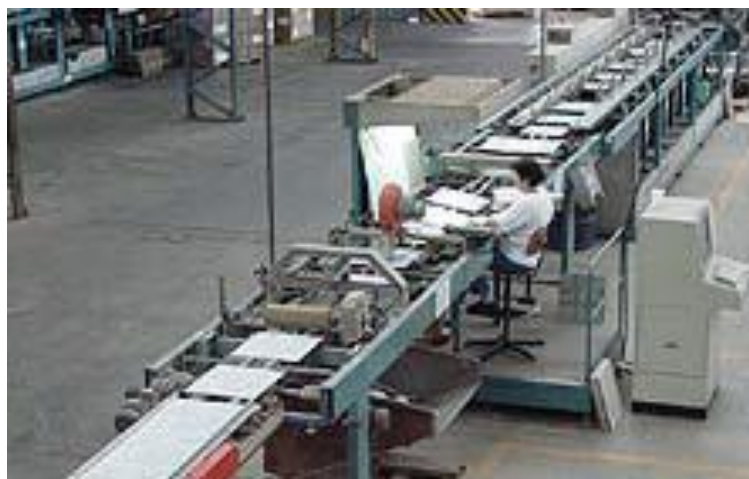
Figura 2.18 Zona de classificação, embalagem, paletização e expedição (KINGERY 1998)
