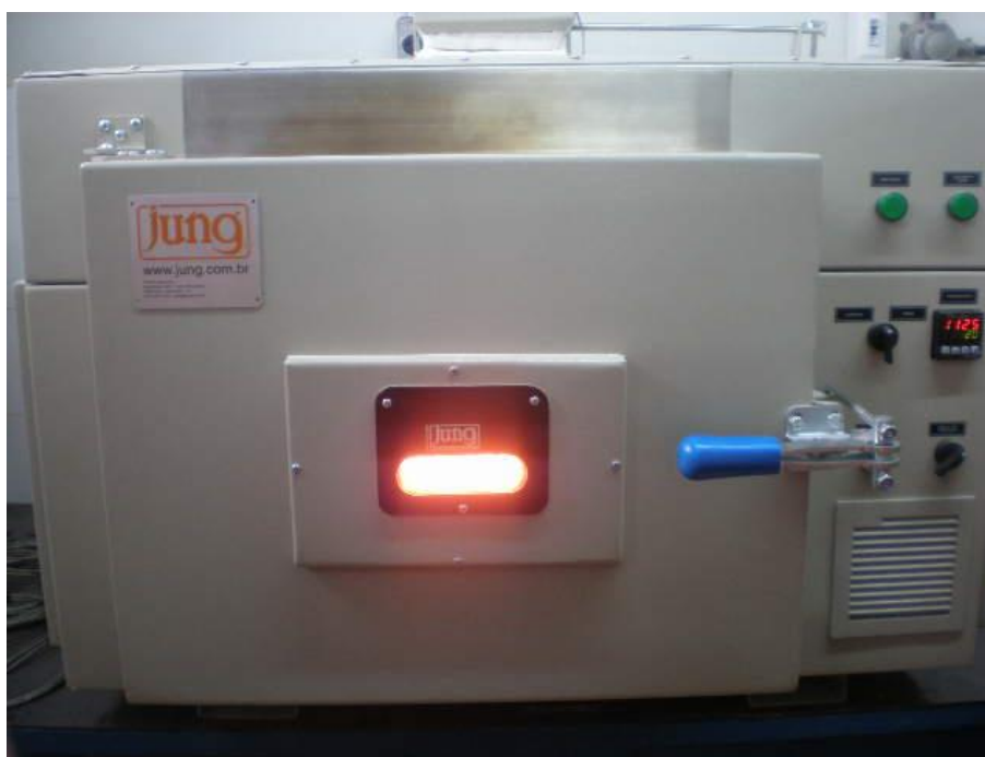
Figura 3.7 Forno laboratorial intermitente utilizado no estudo.
