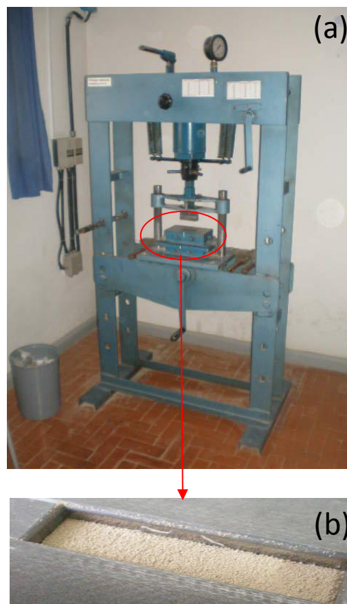
Figura 3.3 (a) prensa hidráulica do colégio Maximiliano Gaidzinski (b) detalhe do compartimento para confecção do corpo de prova com o pó atomizado
