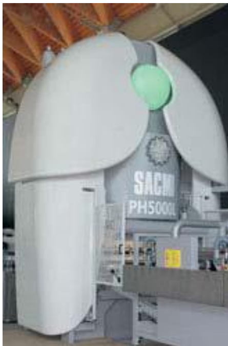
Figura 2.14 Prensa hidráulica industrial utilizada na cerâmica de revestimento (SACMI 2008)
