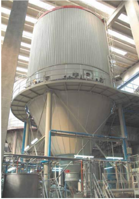
(a) (b) Figura 2.13 Atomizador: (a) sistema físico; (b) vista esquemática (BRISTOT 1996).
