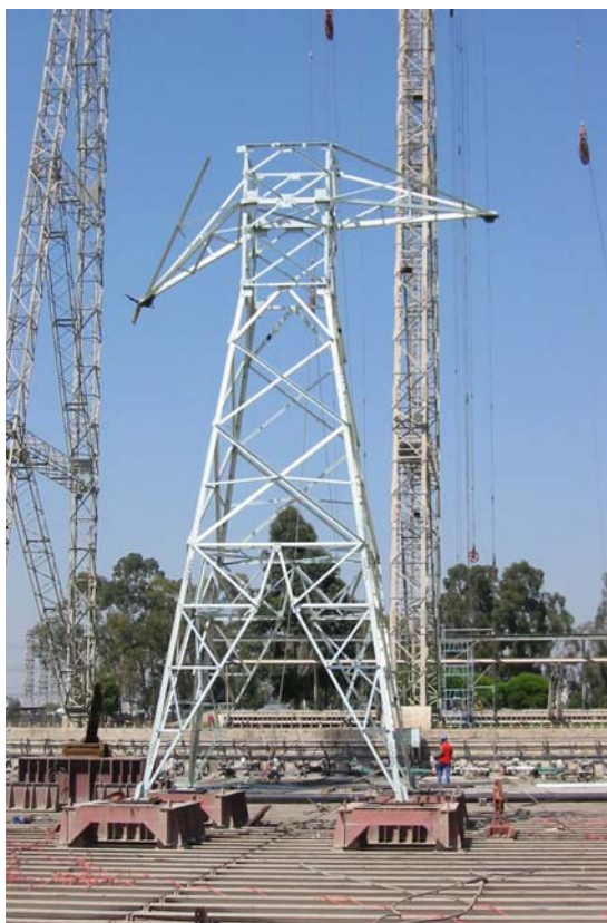
Figura 6.16: Torre “1” após o ensaio de ruptura.
