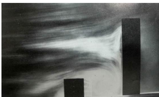
Figura 4 – Fluxo típico do vento em torno de uma edificação
