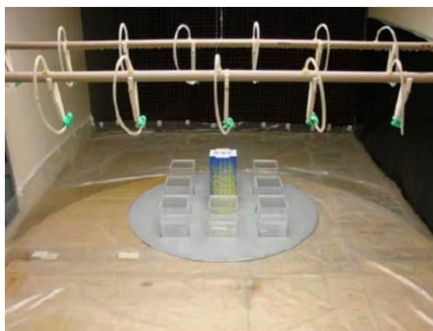
Figura 15 – Ensaio realizado para chuva dirigida
