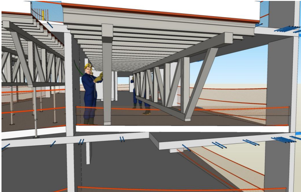
Figura 27 – Retirada do cabo de aço superior
