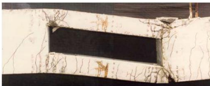
Figura 11 – Ruptura em viga com abertura longa (Mansur 2006)
