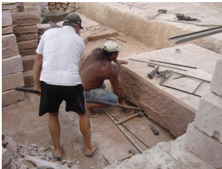
Figura 7 – Extração do bloco de arenito com auxílio de cunha e alavanca
