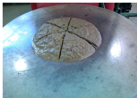
Figura 21 – Medidas de três diâmetros ortogonais do espalhamento da argamassa após 30 golpes na mesa de consistência
