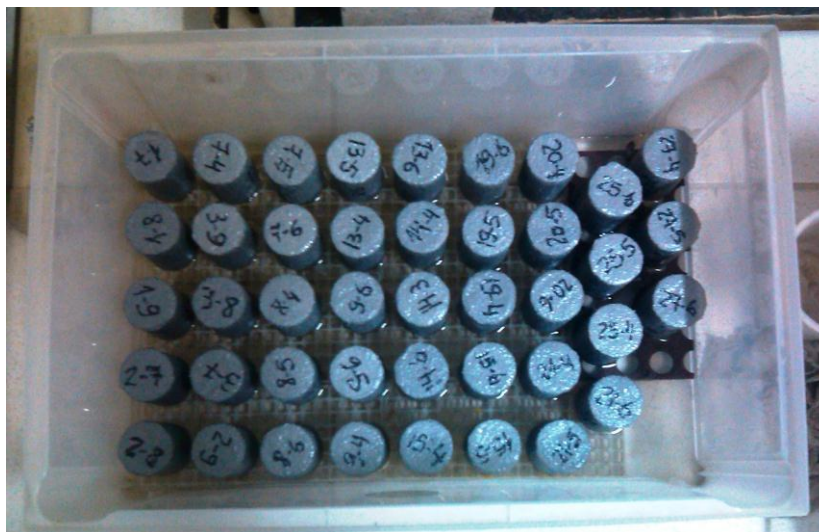
Figura 26 – Vista dos corpos de prova durante o ensaio de absorção por capilaridade
