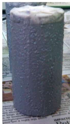
Figura 25 – Corpo de prova com resina epóxi aplicada
