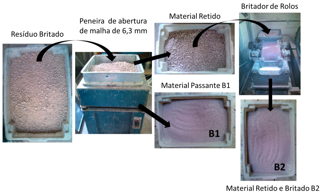
Figura 12 – Esquema do procedimento realizado com o resíduo britado
