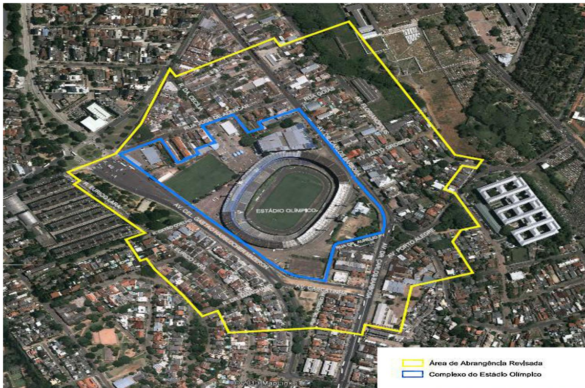
Figura 14: Área de isolamento prevista durante a implosão do Estádio Olímpico Monumental. Fonte: Portal Transparência na Copa, PMPA 12 .
