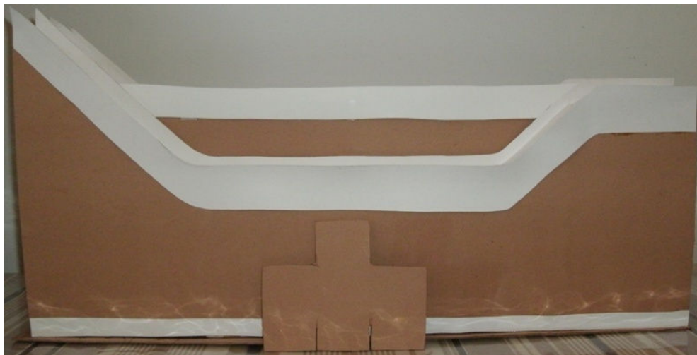
Figura 5 - Imagem lateral do dispositivo mostrando o caminho do trilho III e, ao fundo, do trilho II. Também é mostrada a régua usada para garantir que todas as esferas saiam ao mesmo tempo.
