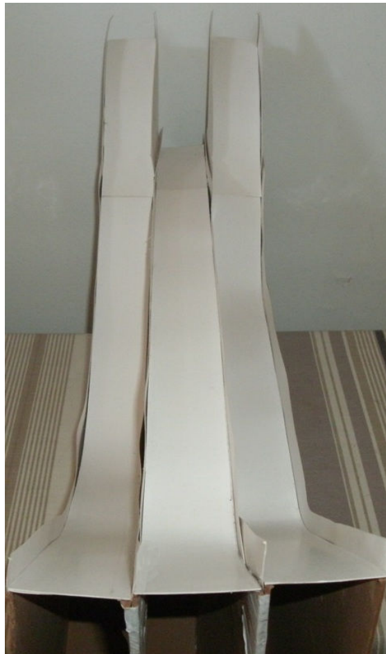
Figura 7 – Foto de frente do dispositivo mostrando os três trilhos e, ao fundo, os trilhos extensores.
