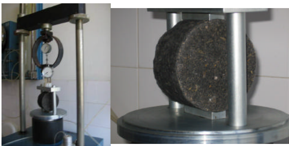
Figura 3. 3 - Prensa para os ensaios de compressão simples e tração por compressão. À direita, detalhe do suporte para o ensaio de tração por compressão diametral.
