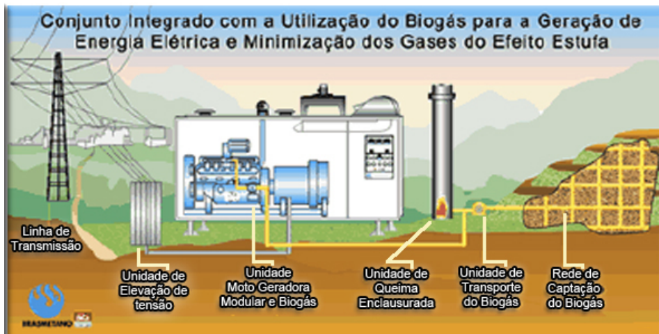
Figura 9 – Sistema integrado de captação e conversão do biogás em energia.
