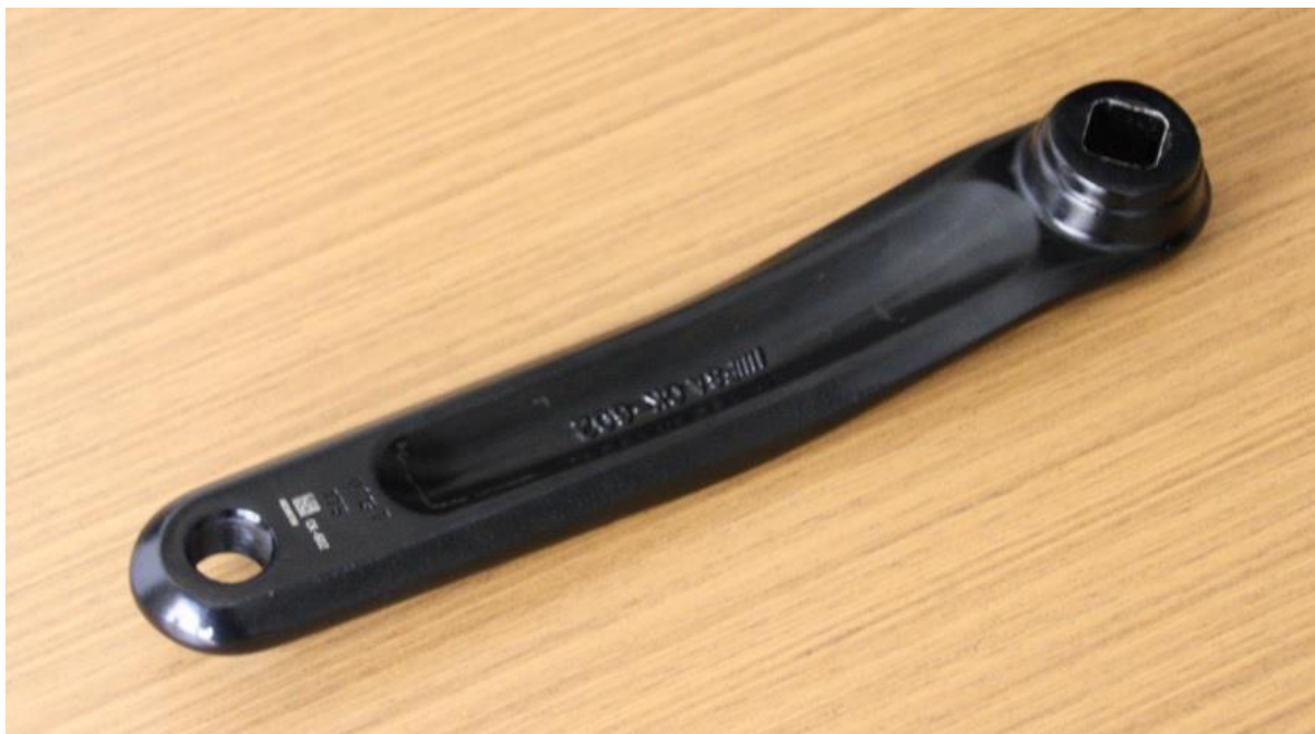
Figura 22. Foto da pedivela comercial VERO FSA-6020 175 mm em liga de alumínio 6071-T6.
