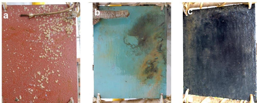
Figura 2.11: Amostras após 2 meses de imersão em ambiente marinho: (a) branco ( primer anticorrosivo); (b) antifouling Intermarine; (c) Tanato de ferro ( TFe_1 ).
