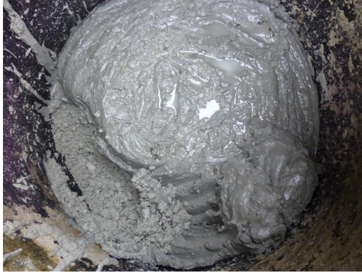
Figura 11: Resíduo aquoso após o processo empírico de recuperação do óleo diesel.
