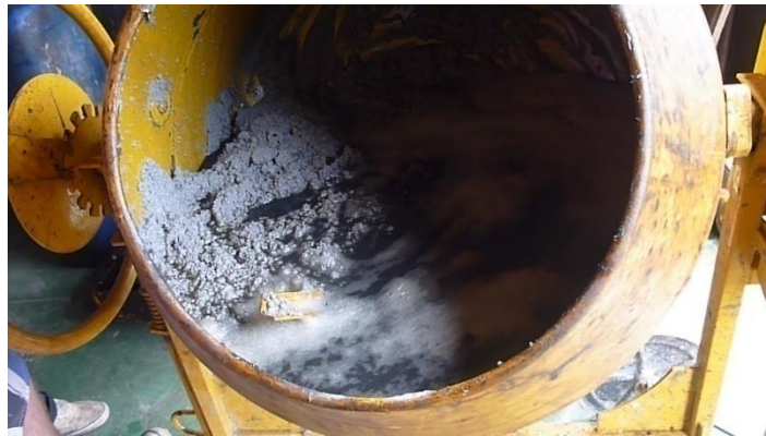
Figura 23: Resíduo oleoso mais água em processo de agitação
