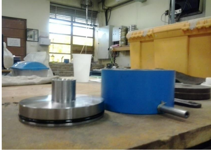
Figura 14: Vista lateral do recipiente empregado nos estudos de prensagem do resíduo.
