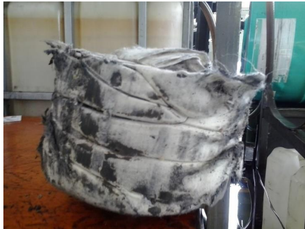
Figura 36: Filtro com resíduo oleoso prensado
