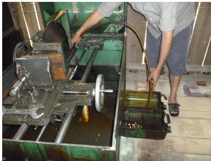
Figura 21: Recuperação do óleo diesel superficial por sifonamento
