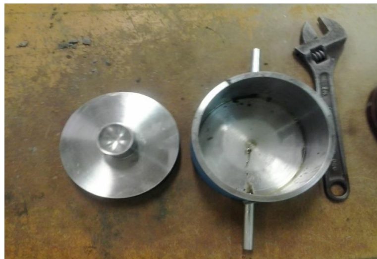
Figura 13: Vista superior do recipiente empregado nos estudos de prensagem do resíduo.
