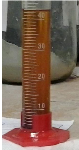
Figura 31: Fluido recuperado através da compressão do resíduo oleoso
