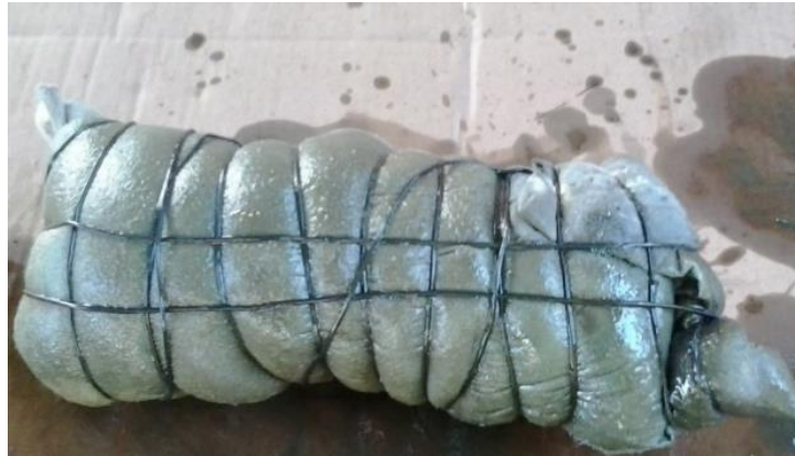
Figura 20: Empacotamento do resíduo da serragem de ágatas para os estudos de prensagem industrial.
