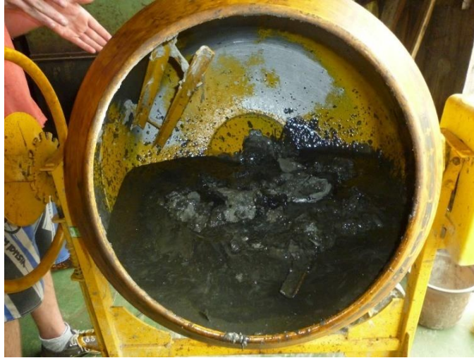
Figura 22: Resíduo oleoso acondicionado na betoneira
