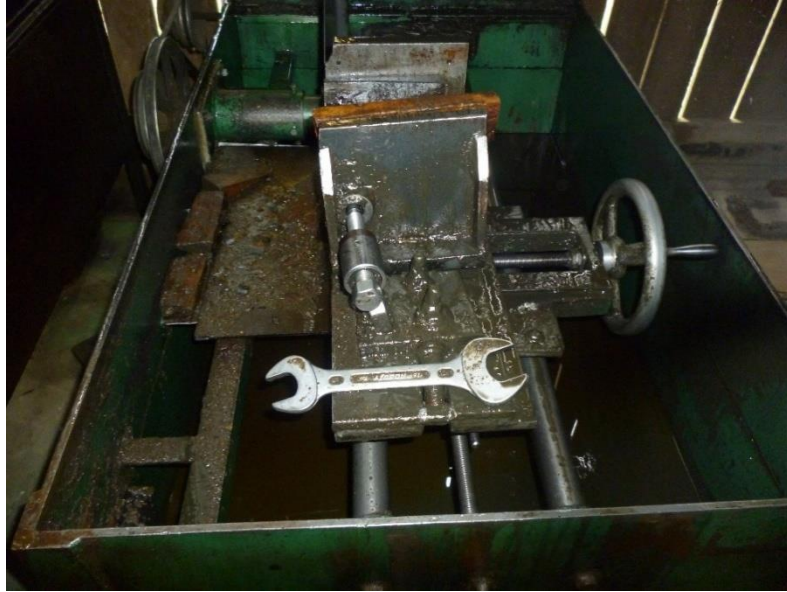
Figura 9: Detalhe da serra caixão com o resíduo oleoso ao fundo
