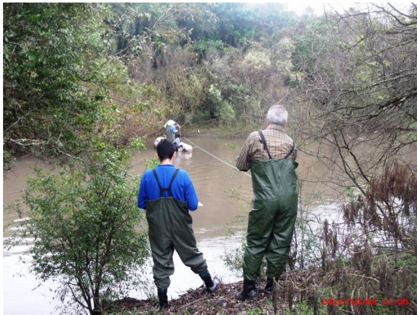
Figura 26. Medição da largura do canal, com auxílio do barco, em riachos profundos.
