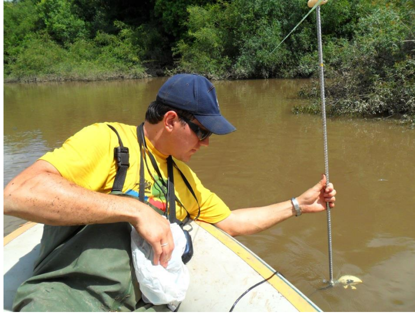
Figura 34. Medida de velocidade de corrente, com auxílio de barco, em riachos profundos. A equidistância horizontal entre as medidas é igual ao dobro da equidistância das medidas de profundidade do perfil molhado.
