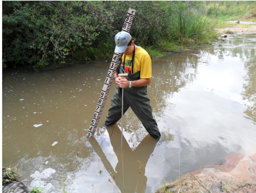
Figura 33. Medida de velocidade de corrente em riachos rasos. A equidistância horizontal entre as medidas é igual ao dobro da equidistância das medidas de profundidade do perfil molhado.
