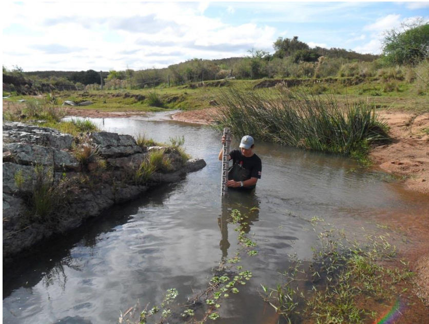
Figura 31. Medida da profundidade do perfil molhado utilizando régua linimétrica graduada em centímetros.
