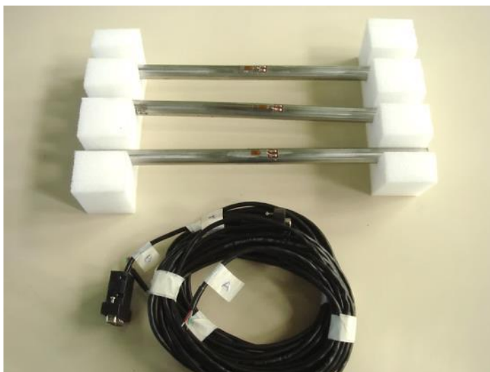
Figura 3-6: Tubos instrumentados para calibração do ensaio de flexão. Fonte: Autor
