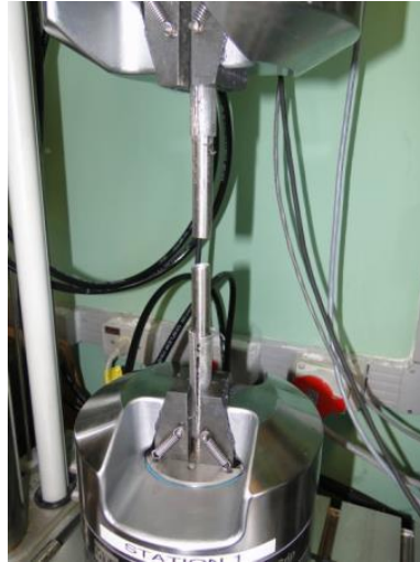
Figura 4-11: Exemplo de amostra com ruptura na região de interesse após ajustes no dispositivo de teste. Fonte: Autor
