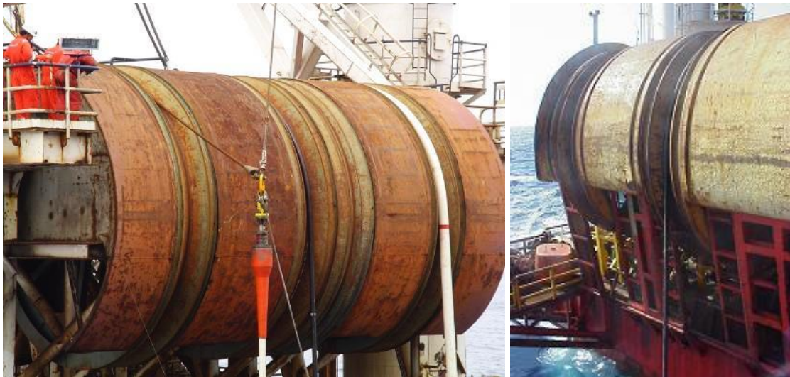
Figura 2-15: Fotos em detalhe de polias de popa. Fontes: Adaptadas de Almeida (2003)
