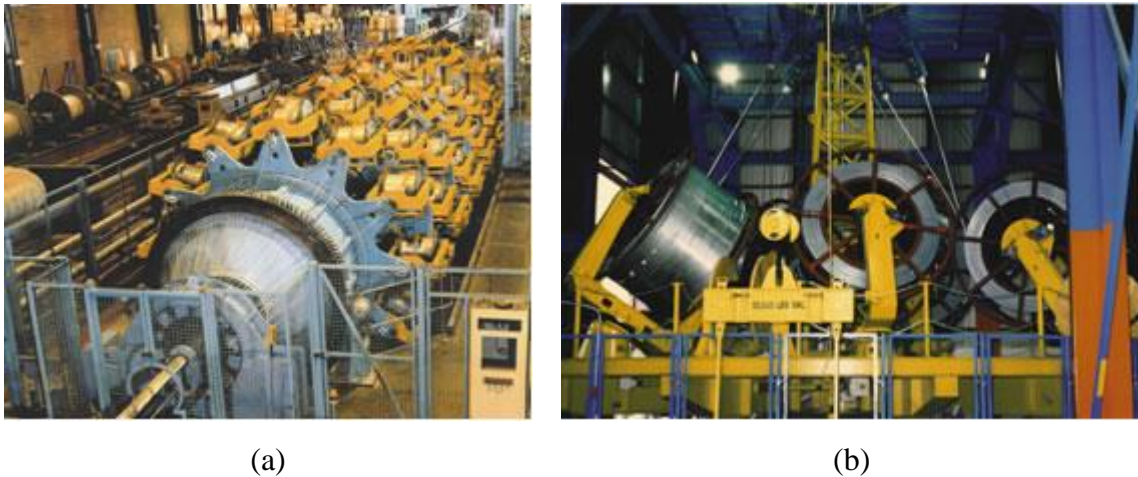
Figura 2-10: Reunidora horizontal (a) e reunidora vertical (b). Fonte: Adaptadas de Almeida (2003)
