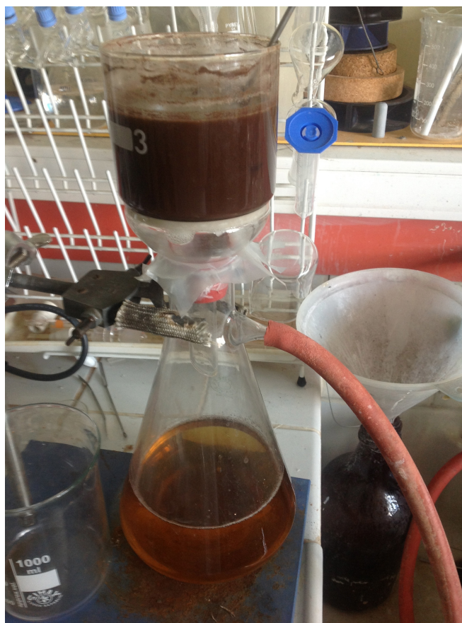
Fig. 6 : Método de purificação da lignina pirolítica.
