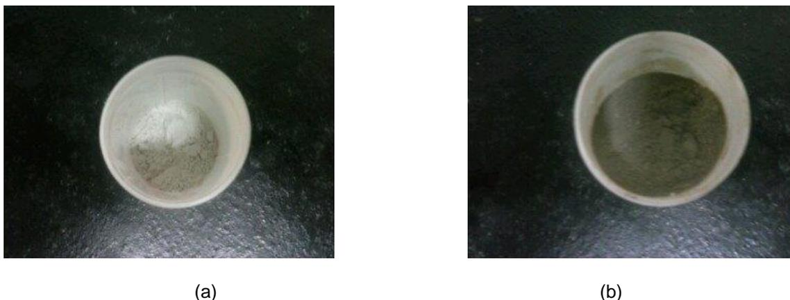
Figura 5.8: Fotos dos pós sintetizados, usando ureia como combustível, com 10 % de lantânio. (a) com excesso de 200% de ureia e (b) com excesso de 100% de ureia.
