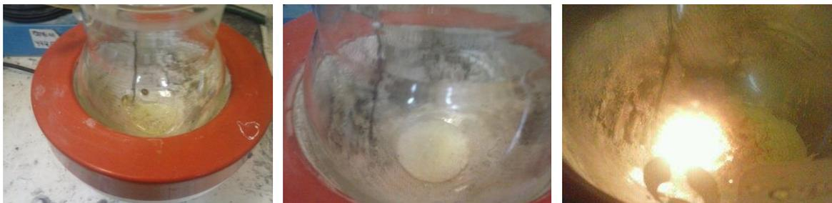
Figura 3.13: Principais etapas de uma síntese por combustão em solução.
