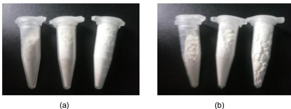
Figura 5.26: Fotos tiras dos pós após a calcinação. Figuras (a) com um excesso de ureia de 200% e (b) com um excesso de sacarose de 100%.
