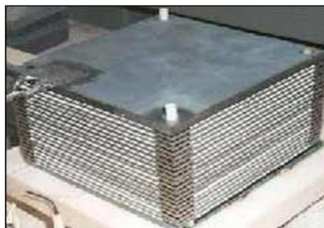
Figura 3.8: Fotos dimensionais de uma SOFC planar em série [35].
