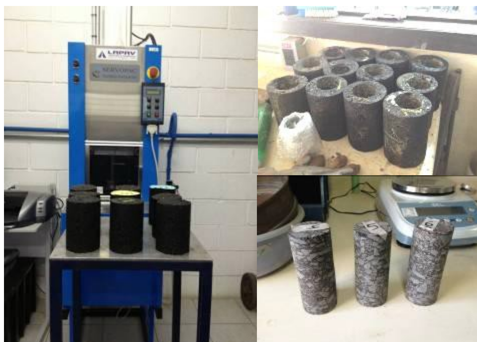
Figura 88. Moldagem dos CPs 100x150 mm utilizando o compactador giratório e extração dos CPs 50x100 mm
