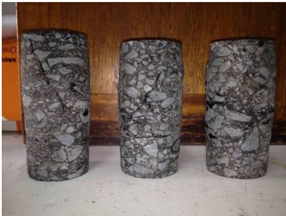
Figura 90. Corpos-de-prova rompidos no ensaio triaxial
