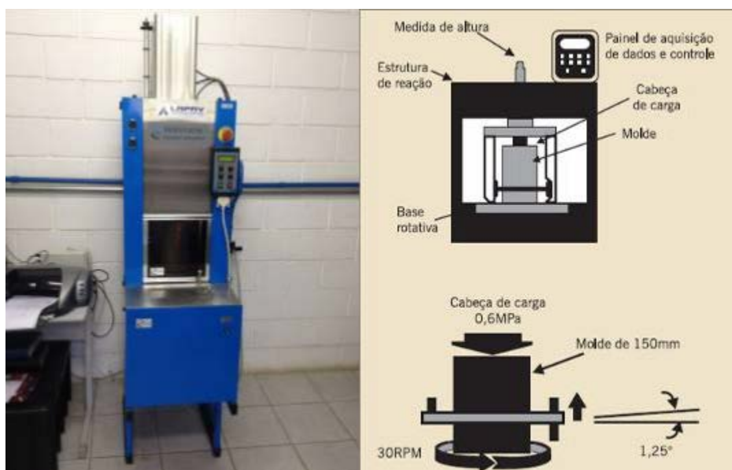
Figura 82. Compactador giratório Superpave (CGS) usado nesta pesquisa
