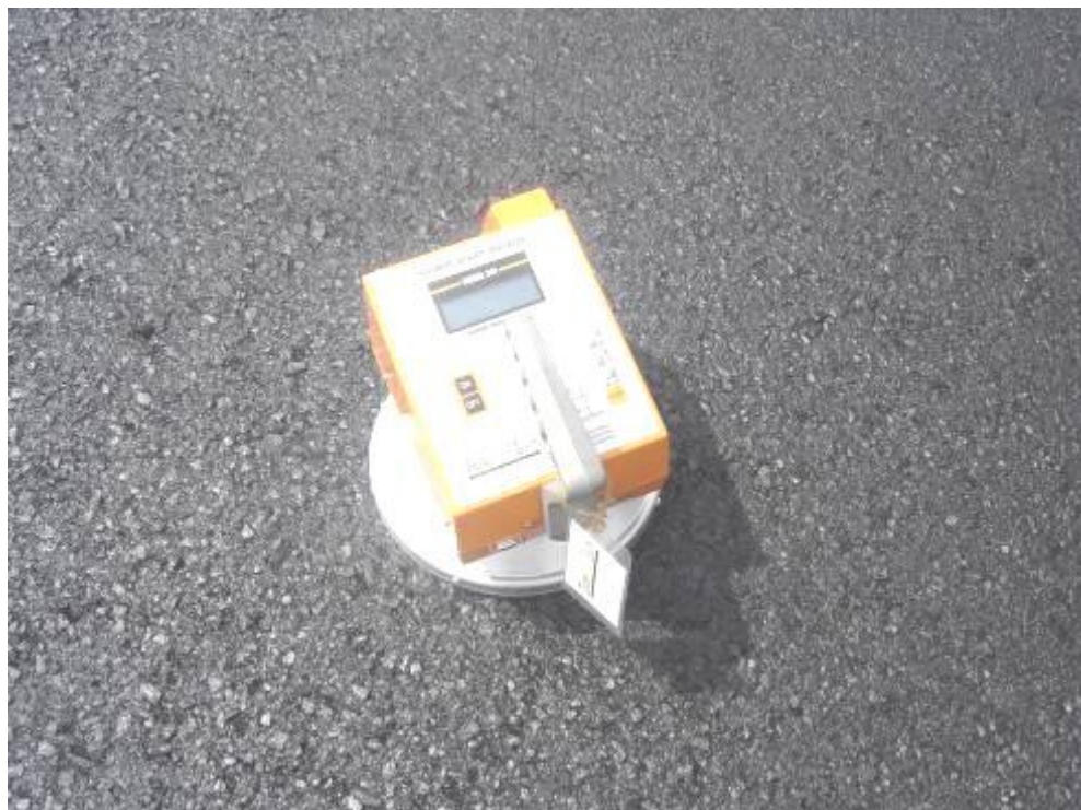
Figura 58. Controle da compactação em campo utilizando o densímetro não-nuclear
