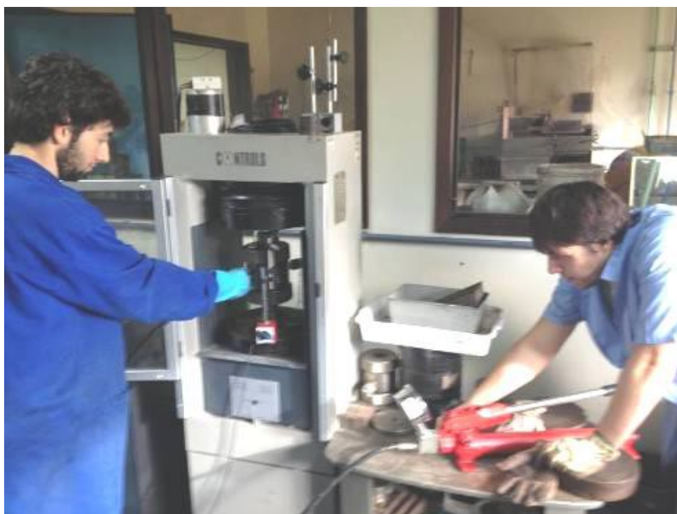
Figura 89. Ensaio triaxial na mistura asfáltica desta pesquisa
