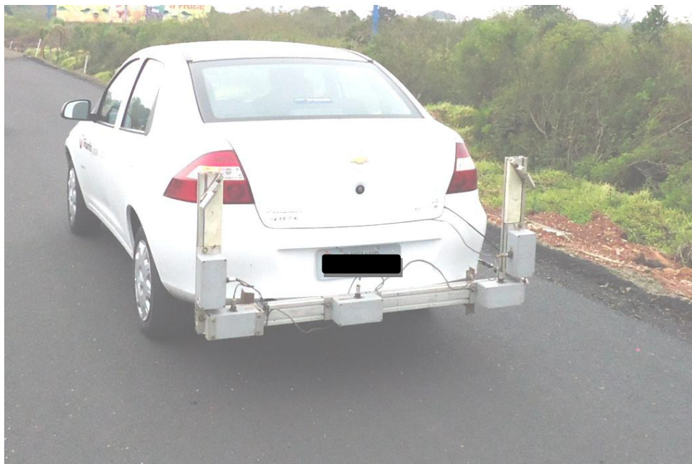
Figura 42. Posicionamento de sensores no levantamento de IRI com medição simultânea de ATR
