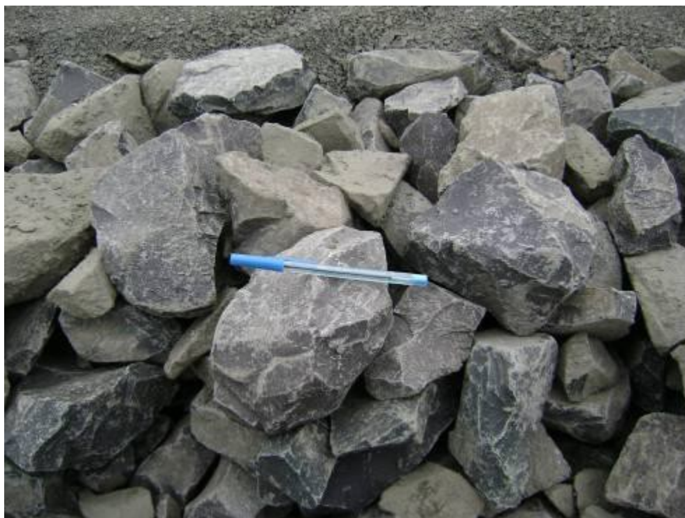
Figura 50. Tamanho do agregado empregado na camada de sub-base dos trechos I e II
