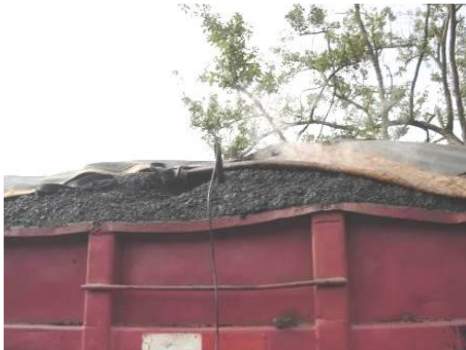
Figura 55. Controle da temperatura da mistura no momento da chegada do caminhão
