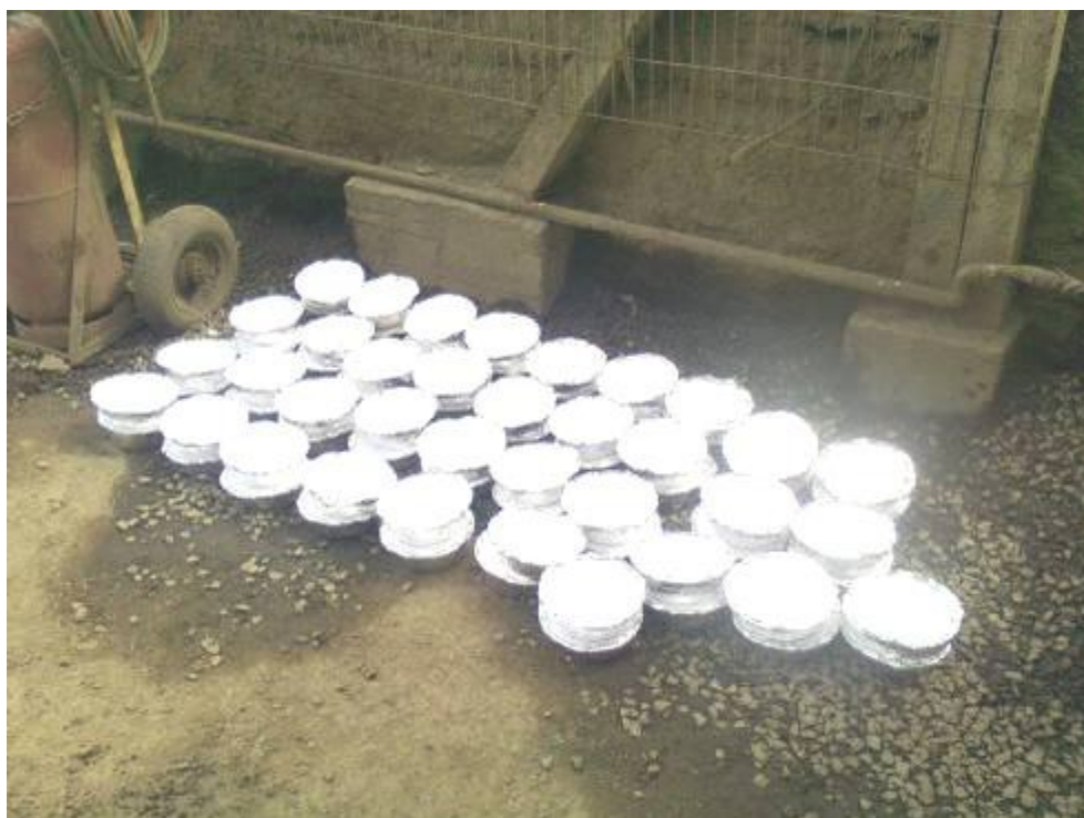
Figura 54. Amostras coletada de mistura asfáltica para ensaios em laboratório
