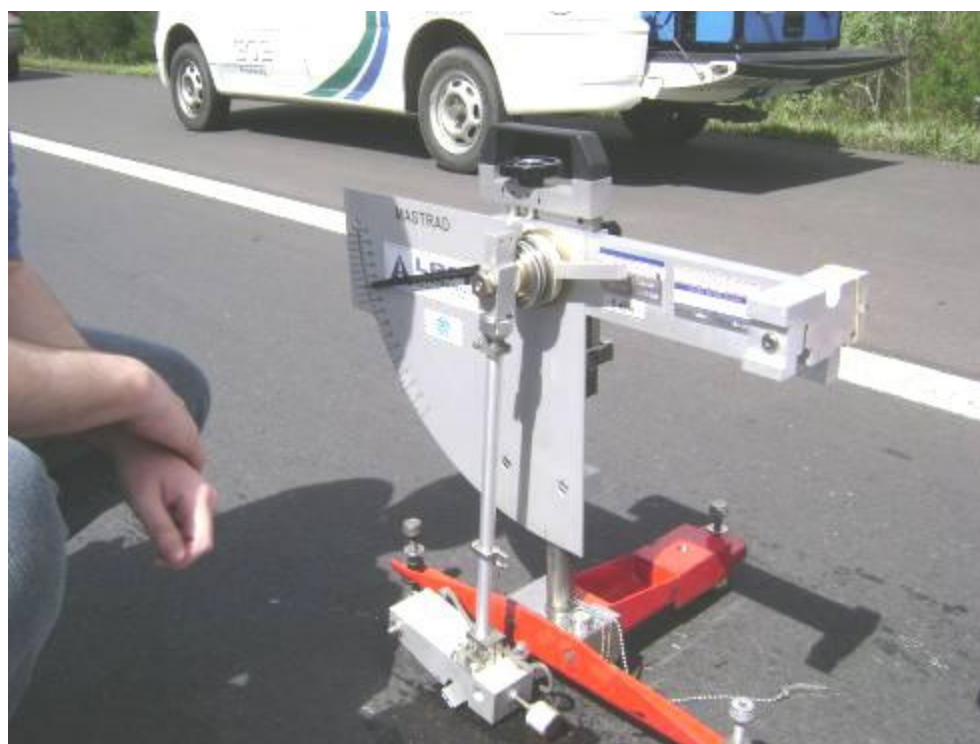
Figura 44. Execução do ensaio com o Pêndulo Britânico (Mattos, 2009)
