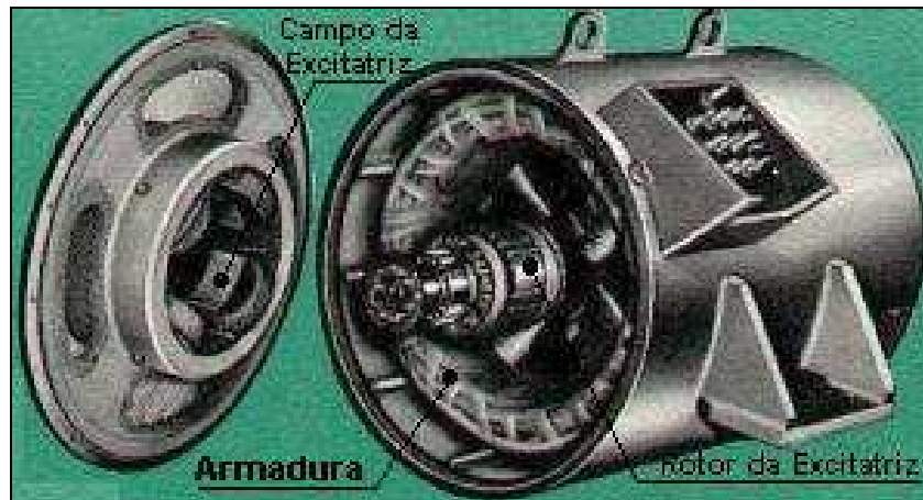
Figura C12 - Gerador síncrono com excitatriz interna
