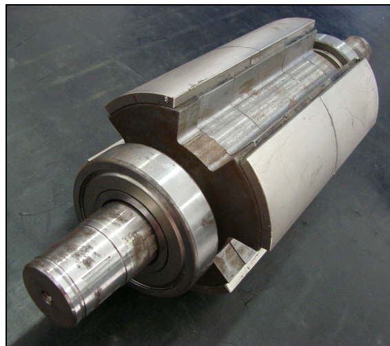
Figura 39 - Fixação dos ímãs
