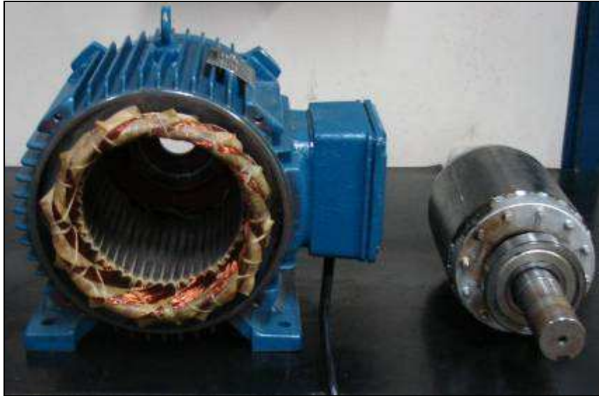
Figura 23 - Motor parcialmente desmontado
