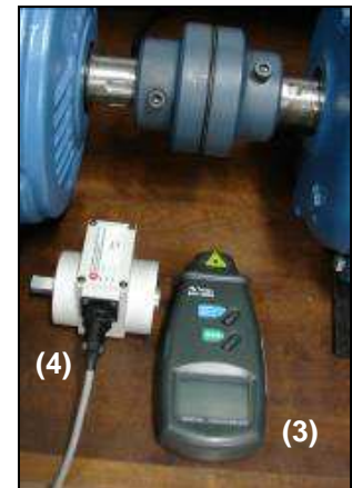
Figura 42 - Osciloscópio (1), datalogger (2), tacógrafo (3) e sensor de torque (4)
