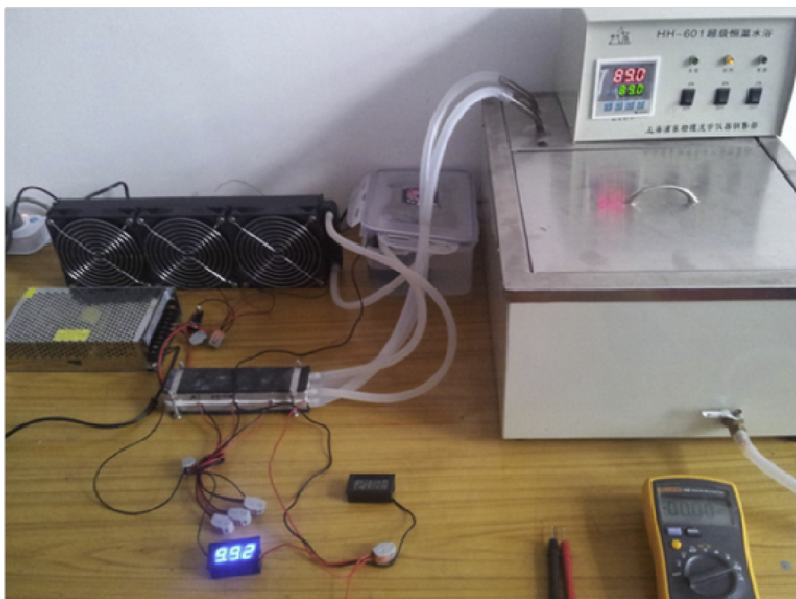
Figura 2.42 – Dispositivo de geração de energia termelétrica experimental [44]
