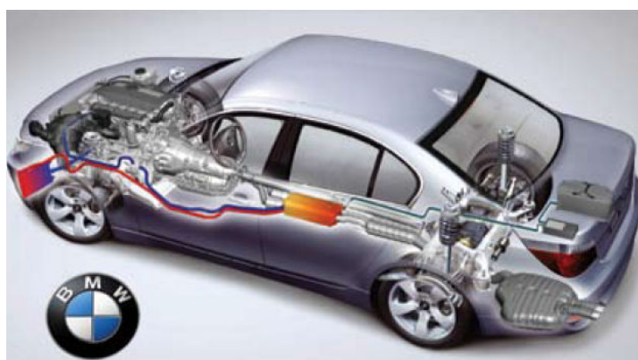
Figura 2.16 - Gerador termoelétrico aplicado no automóvel da BMW [9]
