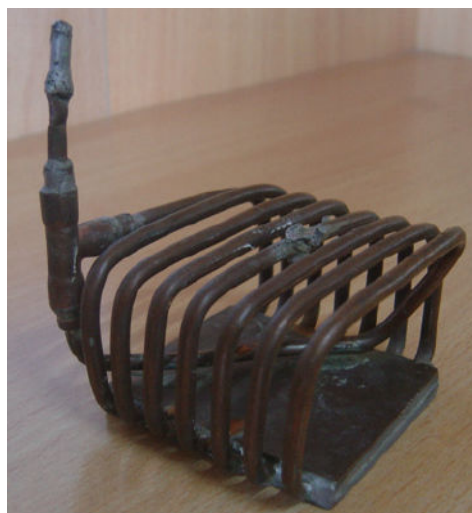
Figura 2.45 – Demonstrativo do Sistema Heat Pipe desenvolvido [48]
