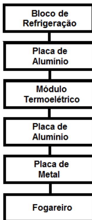
Figura 4.22 - Diagrama de Blocos da Setup da Montagem Experimental
