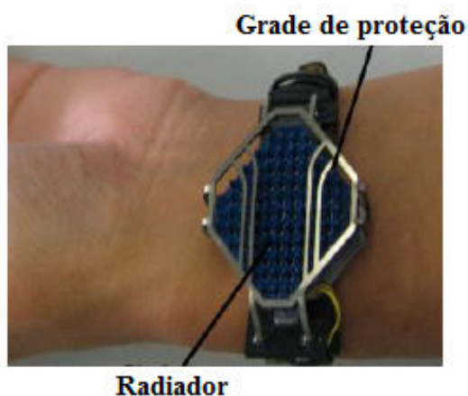
Figura 2.36 – Gerador termoelétrico de pulso desenvolvido pelo grupo de Ziyang Wang [1].
