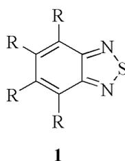
**Figura 2:** Núcleo da 2,1,3-benzotiadiazola (BTD).
