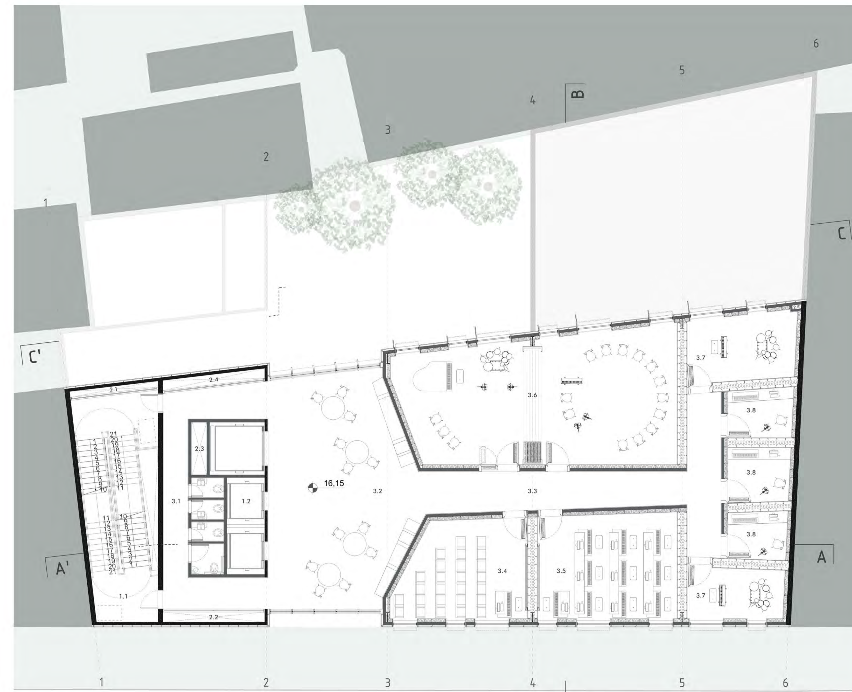
PLANTA BAIXA 4º ANDAR 1:100 ▲ R. ANDRADE NEVES ÁREA CONSTRUIDA: 34,16m 2 1 CIRCULAÇÃO VERTICAL 1.1 escada enclausurada 1.2 elevadores 2 INFRA ESTR. PREDIAL 2.1 insumimento escada 2.2 abastecimento + água 2.3 hidráulica 2.4 A/C + vent. mecânica 2.5 hidráulica + vent. mecânica 3 ESCOLA MÚSICA 3.1 sanitários 3.2 ester 3.3 circulação 3.4 sala aula teórica 3.5 laboratório 3.6 sala prática grande grupo 3.7 sala prática pequeno grupo 3.8 sala prática individual/duplo
