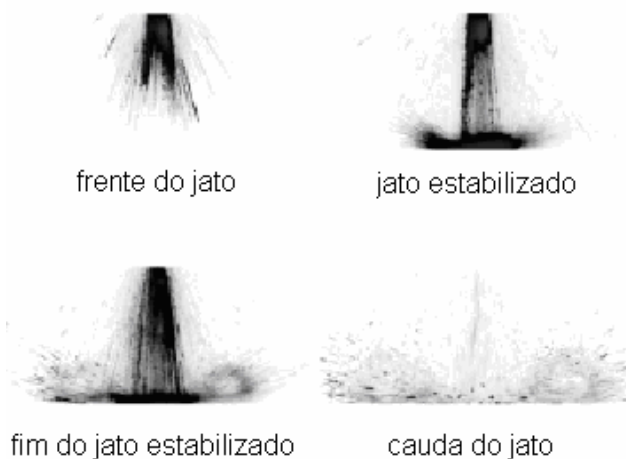
FIGURA2.3 Imagens do jato atingindo uma placa plana. Adaptado de Panão e Moreira (2005).
