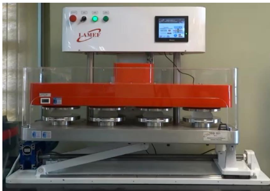
Figura 4.12: Máquina de fadiga com componentes para verticalização sob a base.
