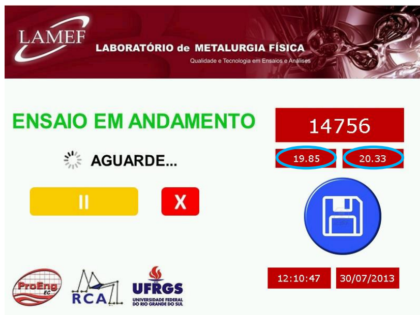
Figura 3.8: Exemplo de registro do IHM mostrando pontos de deslocamento horizontal máximo e mínimo em mm (circulados).
