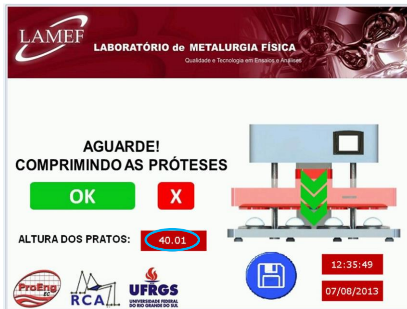
Figura 3.11: Exemplo de registro do IHM mostrando a altura entre os pratos ajustados pela máquina.
