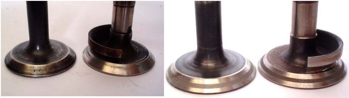
Figura 4.3 a e b – Válvulas de escape e admissão antes e depois da retífica.
