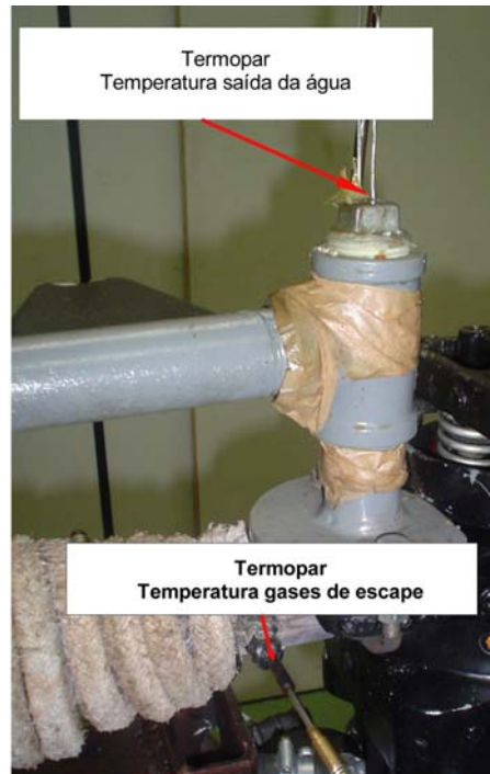
Figura 4.11 - Termopar encapsulado tipo K “Rematel” para verificação da temperatura da água de saída do motor e temperatura dos gases de escape.
