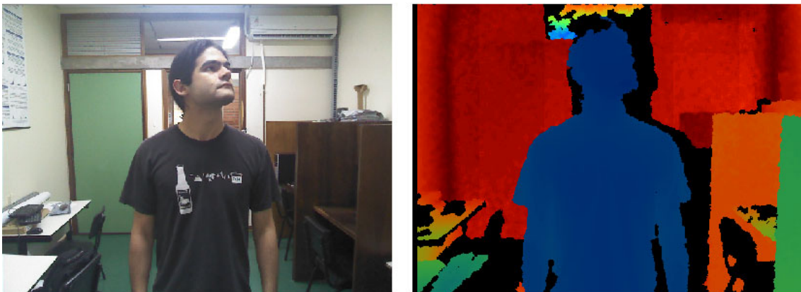
Figura 3.3: Exemplo de um frame RGB(esquerda) e de um frame de profundidade(direita) capturados com o Kinect.
