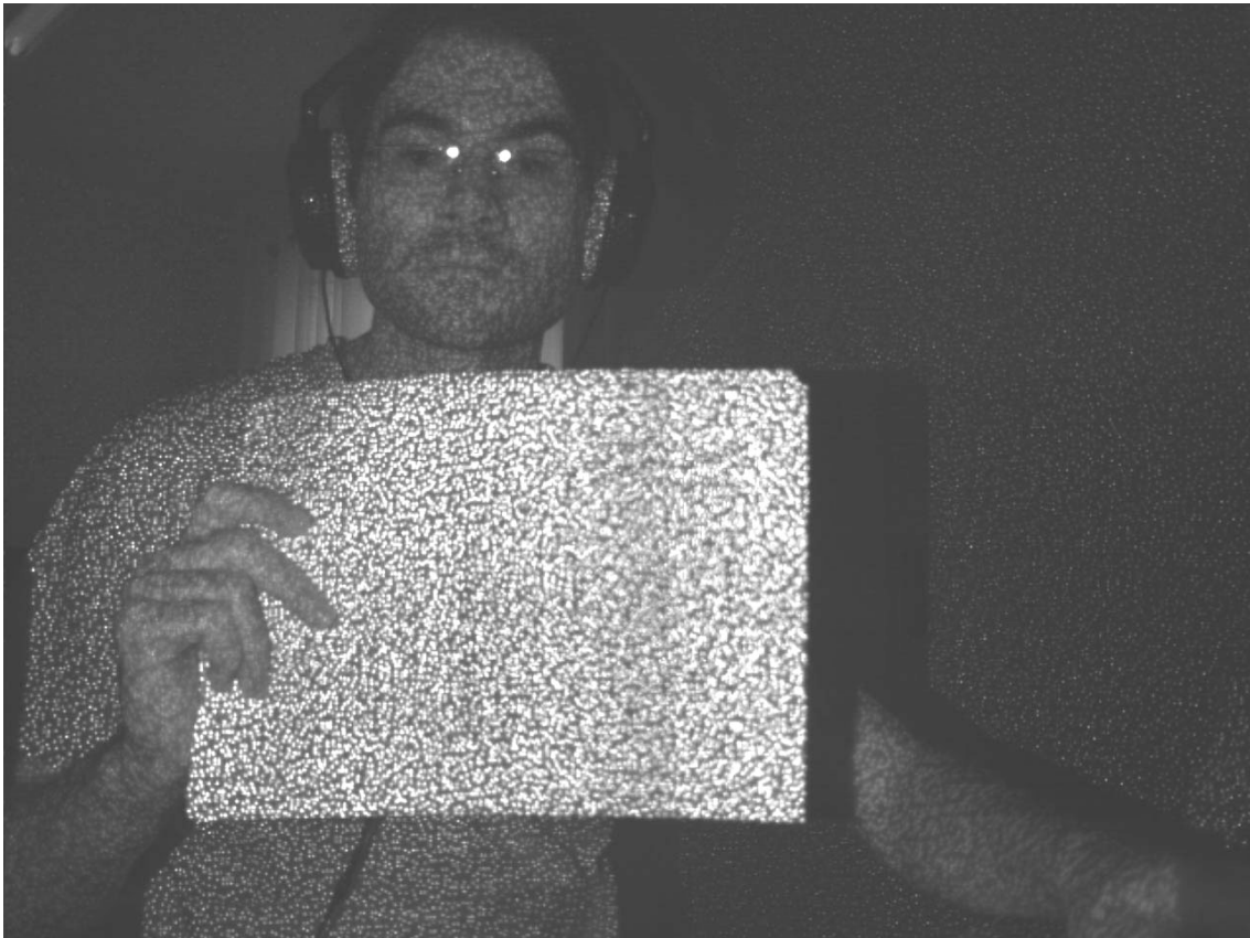
Figura 3.4: Padrão de manchas projetado pelo emissor de infravermelho do Kinect capturado pela câmera de infravermelho.
