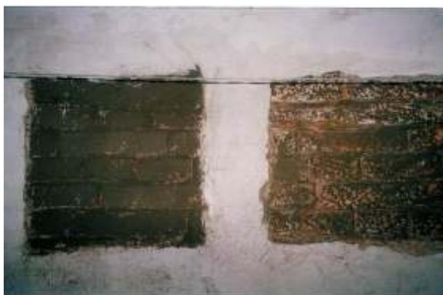
Figura 66: aplicação de chapisco em 100% (argamassa convencional) e em 50% (argamassa de saneamento) sobre o substrato
