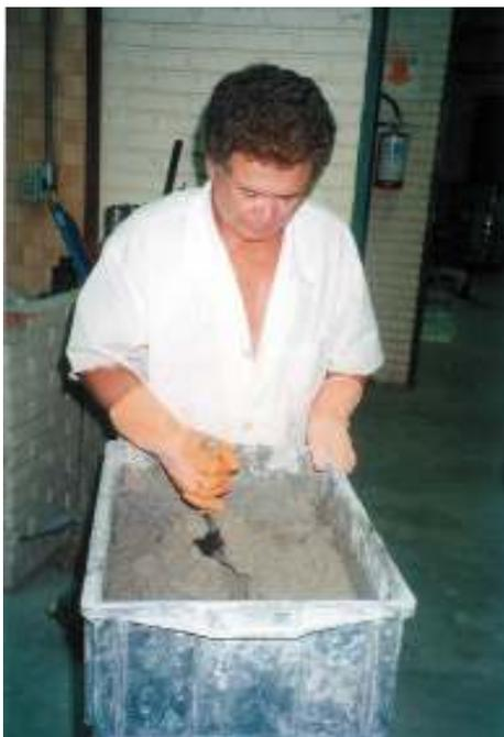
Figura 34: argamassa feita manualmente em laboratório
