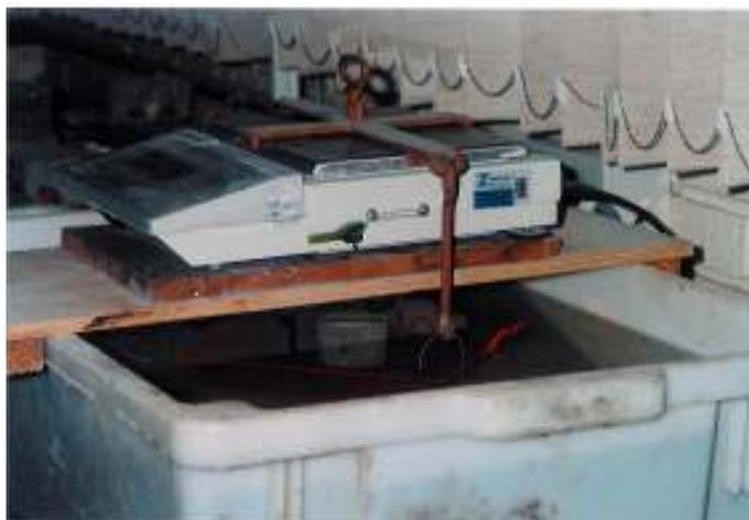
Figura 47: pesagem do corpo-de-prova imerso em água
