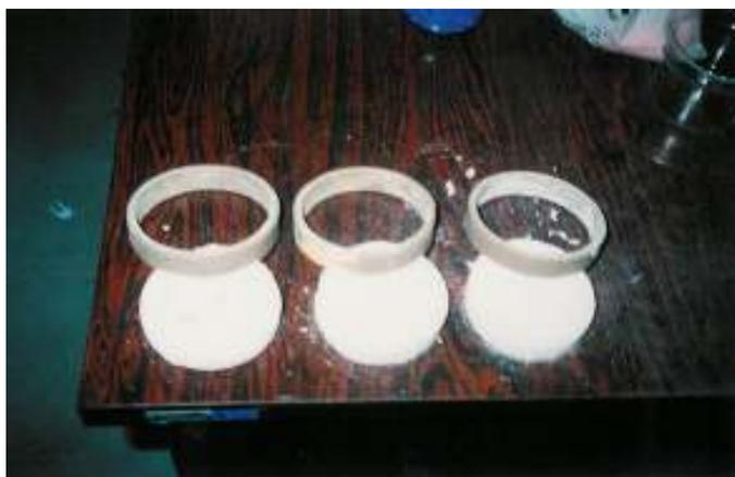
Figura 36: corpos-de-prova  $\varnothing=20\text{mm}$  e  $h=100\text{mm}$  com os moldes em PVC
