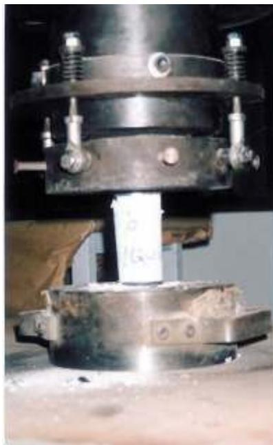
Figura 41: corpo-de-prova submetido à compressão
