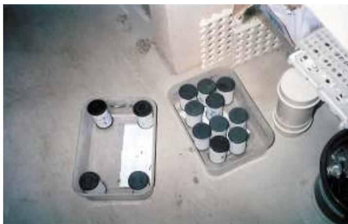
Figura 40: corpos-de-prova capeados para o ensaio de resistência à compressão
