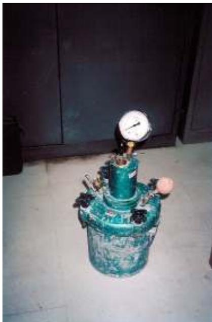
Figura 37: aparelho que mede a incorporação de ar, conforme NBR-NM 47:2002
