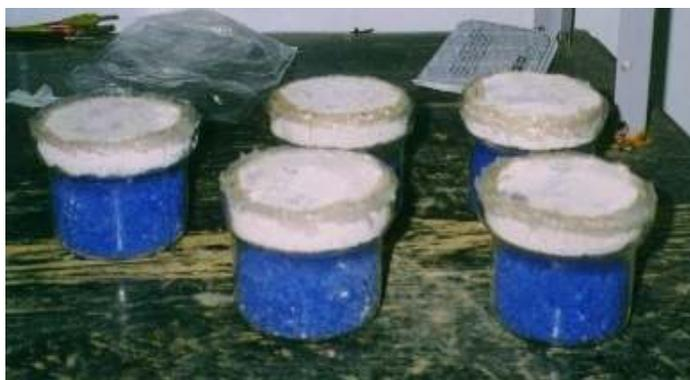
Figura 39: corpos-de-prova encaixados em frascos de vidro contendo sílica-gel
