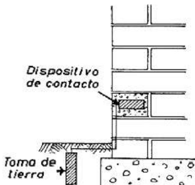
Figura 13: condutores isolados entre os tijolos e a terra (ULSAMER, 1995). *Dispositivo de contacto*: tijolo vasado com lâmina de cobre no seu interior. *Toma de tierra*: grelha de cobre
