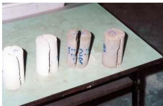
Figura 44: corpos-de-prova rompidos à tração por compressão diametral
