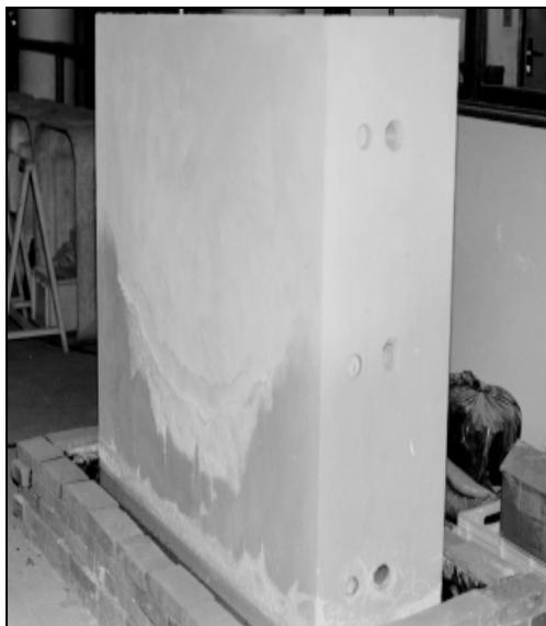
Figura 17: face da parede que foi aquecida pelo quadro de lâmpadas, e a formação de eflorescências em duas regiões distintas abaixo da linha seca e imediatamente superior a superfície da solução de contaminação (RUARO, 1997)
