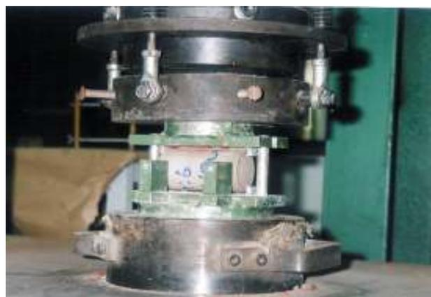
Figura 43: corpo-de-prova submetido à tração por compressão diametral
