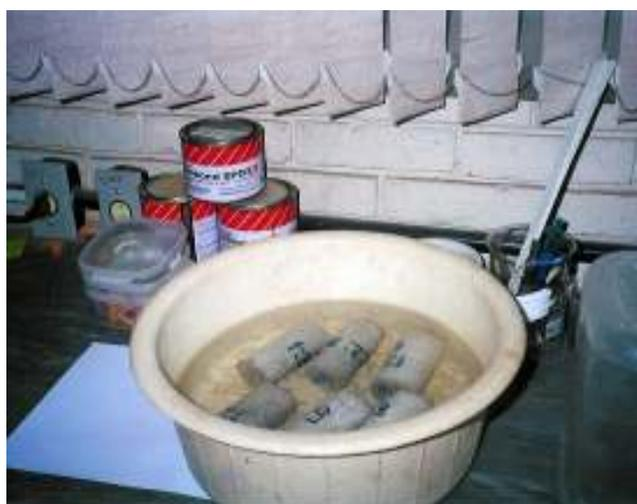
Figura 45: corpos-de-prova imersos por 72 horas
