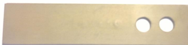
Figura 17 - Cupom de aço utilizado para o corte dos corpos de prova
