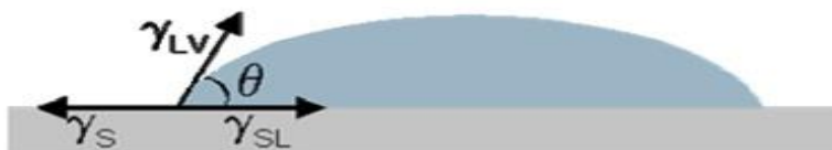
Figura 21 - Definição de ângulo de contato \theta entre uma gota líquida e uma superfície plana e horizontal. \gamma_S e \gamma_{LV} são a energia de superfície do sólido e a tensão superficial do líquido em equilíbrio com o vapor; \gamma_{SL} é a energia da interface sólido-líquido [61]
