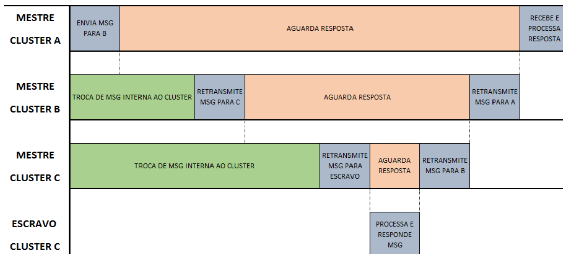
Figura 15 – Diagrama de tempo de uma mensagem retransmitida por um cluster intermediário – Fonte: Autor
