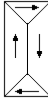
Figura 2.3.1 - Possível estrutura de domínios magnéticos em um cristal com dois eixos de fácil magnetização.
