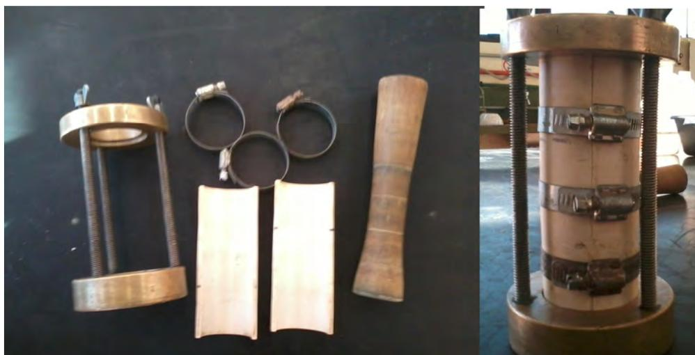
Figura 5.6 – Molde utilizado na elaboração dos corpos de prova.
