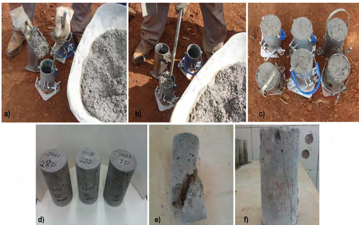
Figura 6.28 – Procedimentos para a amostragem e ensaio de resistência à compressão simples dos corpos de prova em concreto, desde a sua (a) moldagem em camadas, (b) aplicação dos golpes, (c) seu aspecto na forma e (d) após desmoldagem, até (e) e (f) à sua ruptura.
