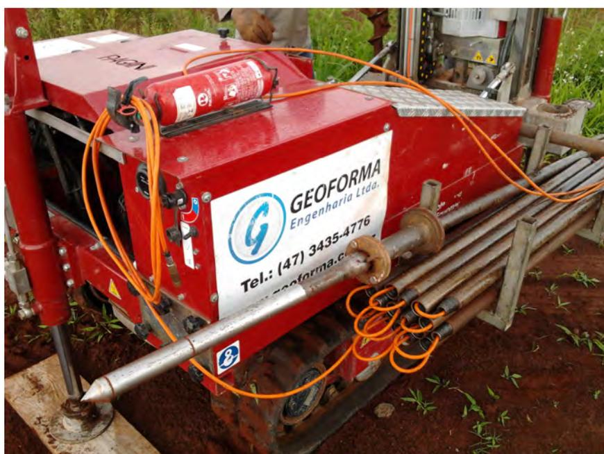
Figura 6.7 – Equipamento utilizado para a execução dos ensaios de *Cone Penetration test* (CPT).
