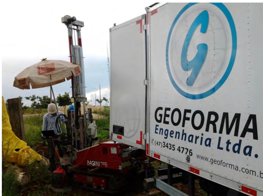
Figura 6.6 – Aparato e execução dos ensaios de *Cone Penetration Test* (CPT).
