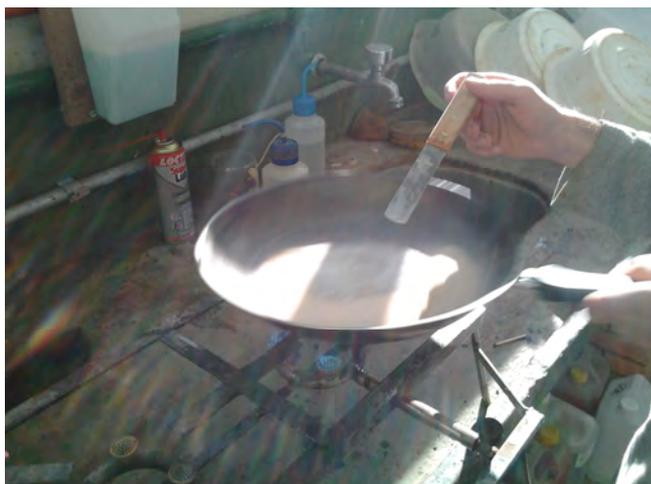
Figura 6.36 – Execução do ensaio da frigideira.
