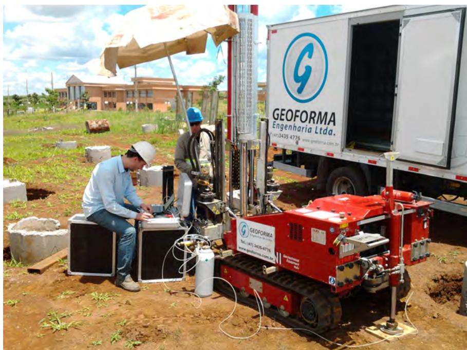
Figura 6.9 – Aparato e execução dos ensaios de *Flat Dilatometer Test* (DMT).
