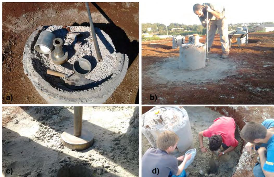
Figura 6.37 – Execução do ensaio de massa específica no solo cimento, com (a) a apresentação dos materiais, (b) cravação do cilindro, (c) cilindro totalmente cravado e (d) escavação para retirada do cilindro.
