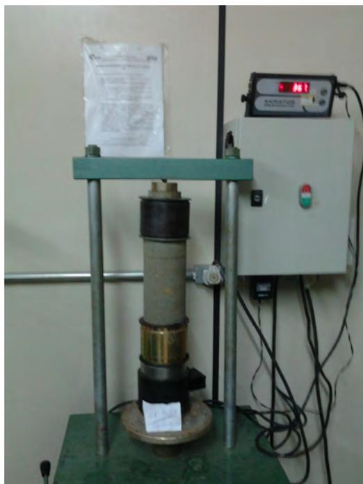
Figura 5.8 – Prensa utilizada para a realização dos ensaios.
