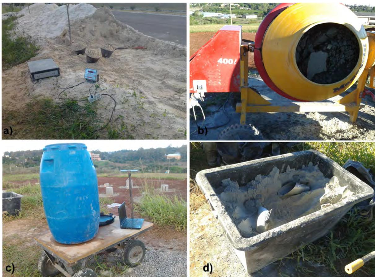
Figura 6.33 – Equipamentos e materiais utilizados para a execução da mistura de solo cimento em campo experimental, com (a) balança, extensão, baldes e areia, (b) betoneira, (c) computador e reservatório de água e (d) reservatório de cimento e conchas.
