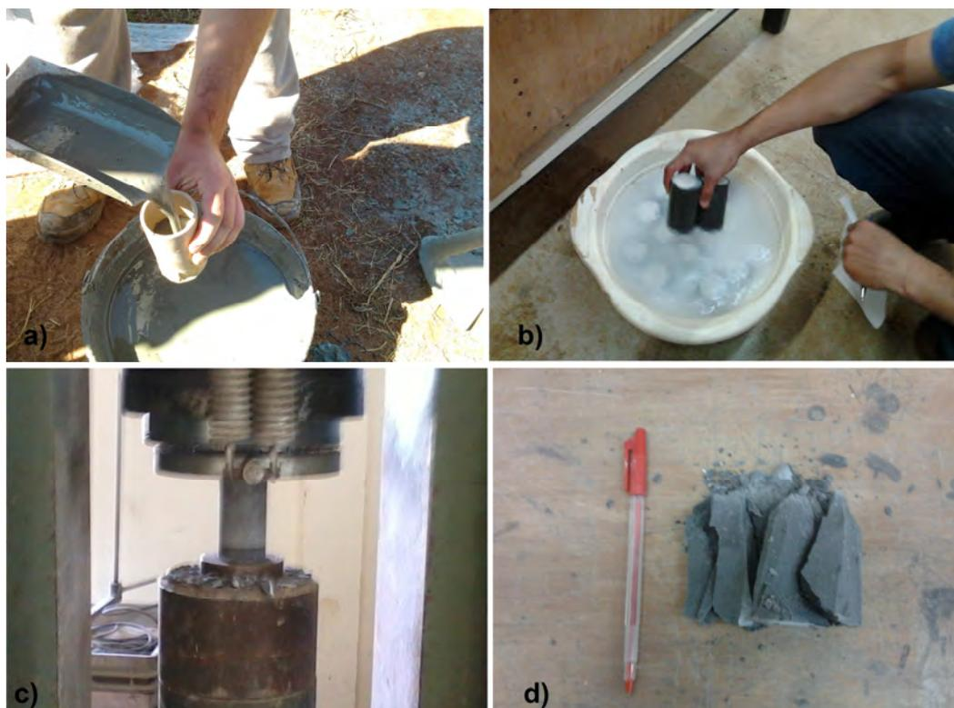
Figura 6.30 – Procedimentos para a amostragem e ensaio de resistência à compressão simples dos corpos de prova de calda de cimento, desde a sua (a) moldagem e (b) colocação em água saturada de cal, até ao (c) ensaio de compressão simples e (d) aspecto após ruptura.
