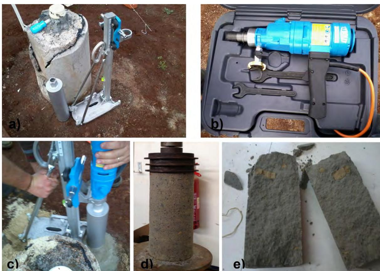
Figura 6.38 – Procedimentos do ensaio com sonda rotativa no solo cimento, com a (a) e (b) apresentação dos materiais, (c) extração dos testemunhos, (d) corpo de prova submetido a ensaio de compressão simples e (e) seu aspecto final após ruptura.
