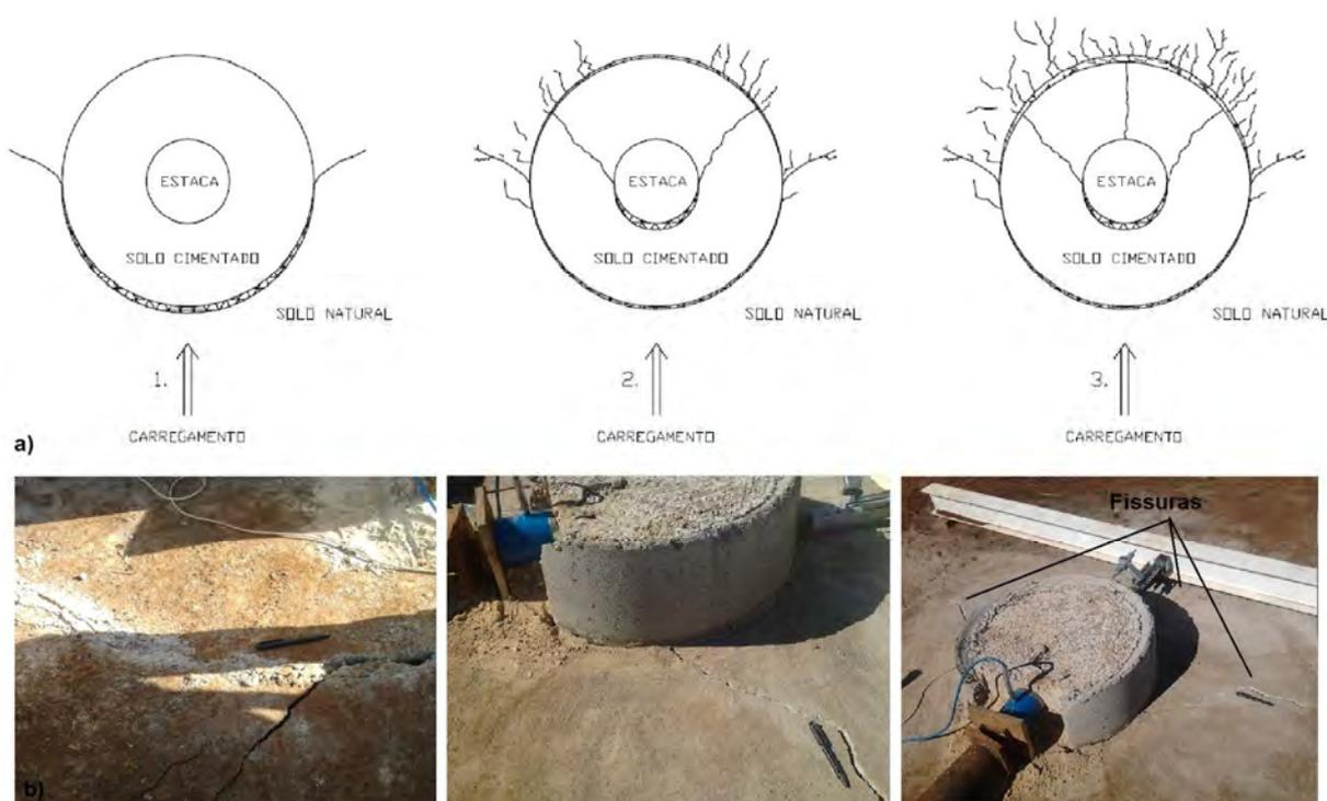
Figura 6.95 – Mecanismo de ruptura (fissuração) do solo cimento contendo 7% de cimento: (a) desenhos ilustrativos e (b) fotos.
