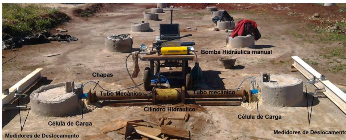
Figura 6.40 – Vista geral do ensaio de carregamento horizontal em estacas.
