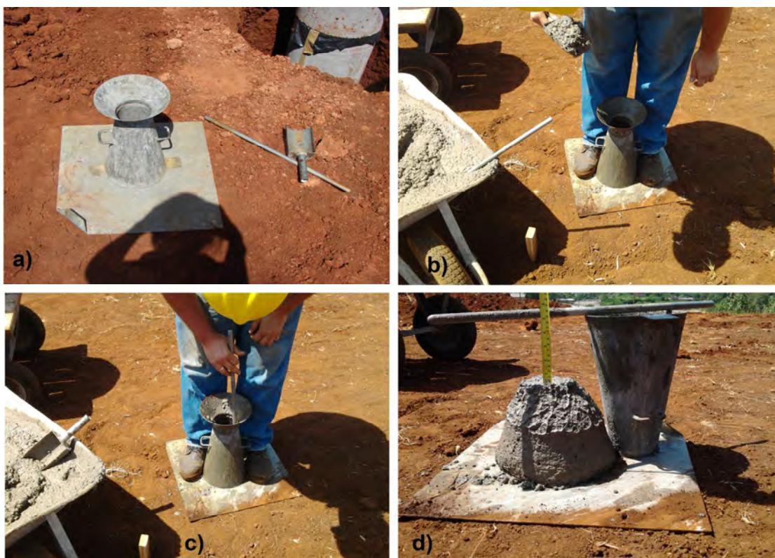
Figura 6.27 – Procedimentos do ensaio de abatimento (slump-test), com (a) os materiais utilizados, (b) preenchimento do cone metálico, (c) aplicação dos golpes e (d) medição do abatimento do concreto.
