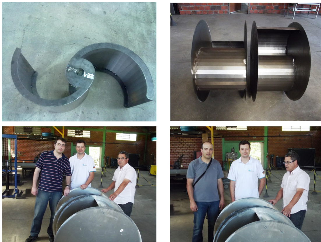
Figura 1.2 – Imagens do projeto de um rotor Savonius hidrocínético [Tremarin, 2013]
