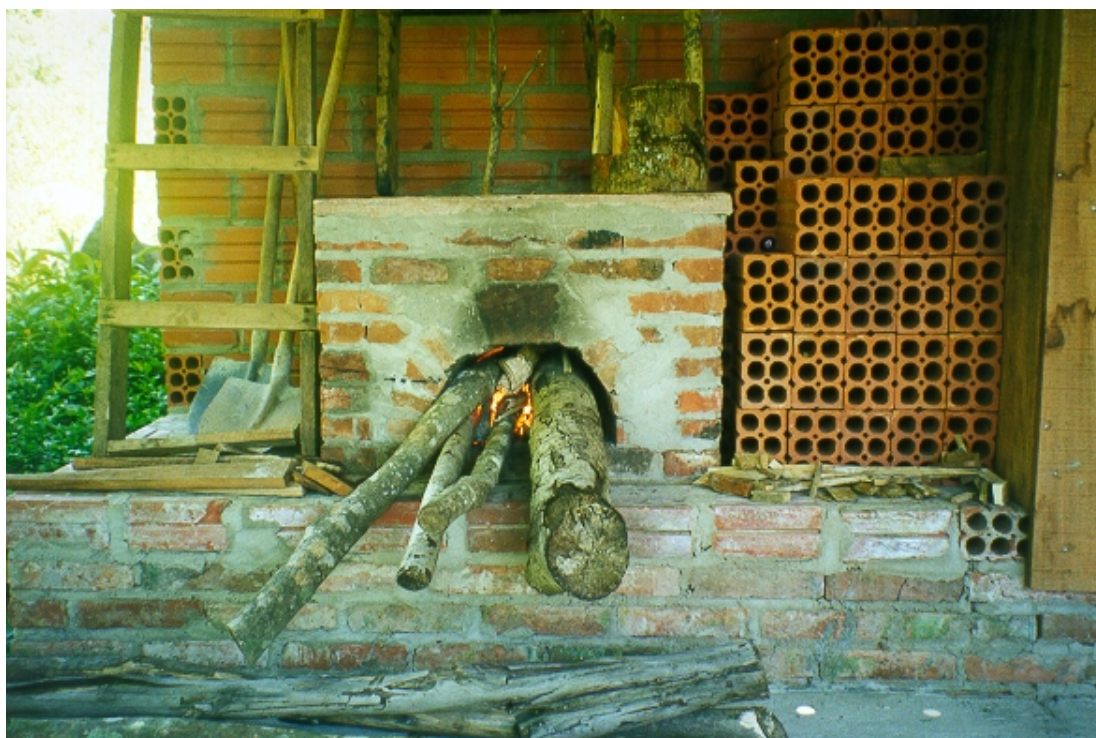
FIGURA 15. Sistema de aquecimento da estufa através da queima da lenha.
